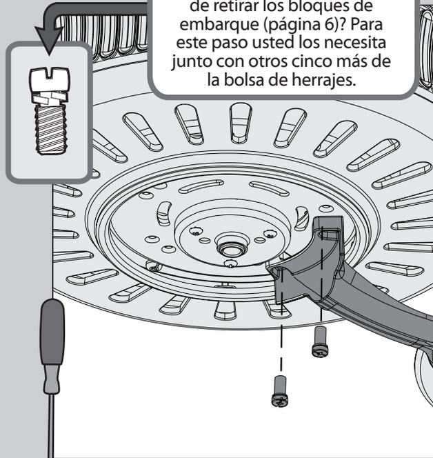
⊗ Acople sin emplear mucha fuerza los soportes de paleta al motor con los tornillos de la bolsa de materiales ⊗, luego apriete con firmeza, cuando ambos tornillos estén acoplados.
