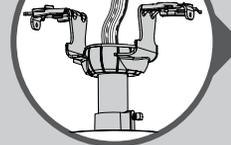
Usando un conector de alambre anaranjado de la bolsa de materiales ★, conecte los 3 alambres de puesta a tierra (verde, verde con banda amarilla, y cobre desnudo) del ventilador, la varilla y el soporte de suspensión.
