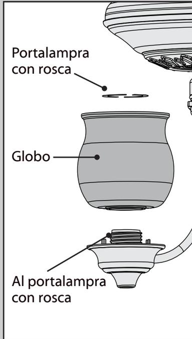
Coloque el globo en el portalampara con rosca y enrosque el anillo con rosca, al portalampara con rosca, asegurando el globo al portalampara con rosca.
