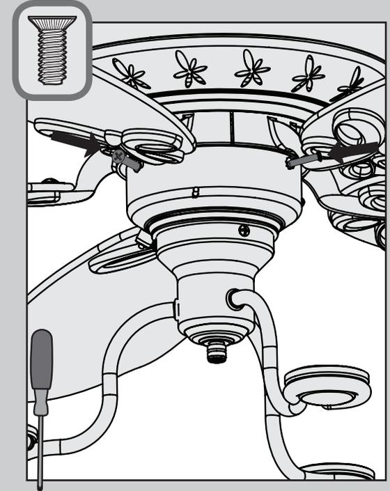
⊗ Instale los tres tornillos de caja del interruptor incluidos en la bolsa de materiales ≡.
