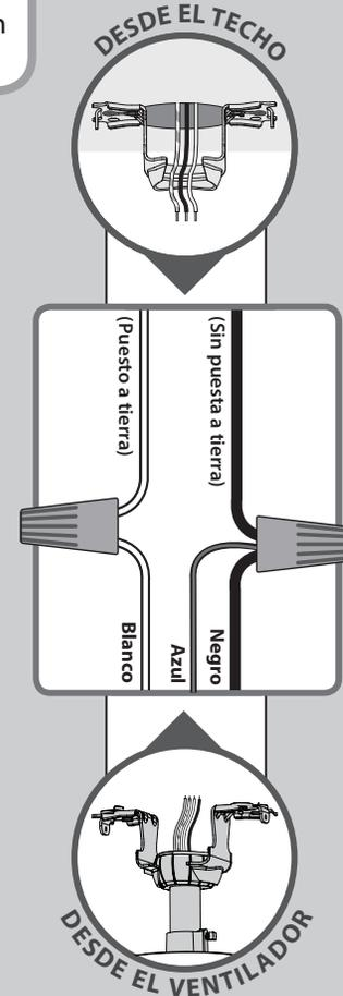
Usando los conectores de alambre anaranjados de la bolsa de materiales ★, conecte el alambre negro (sin puesta a tierra) del ventilador con los alambres negro y azul provenientes del ventilador. Conecte el alambre blanco (puesto a tierra) del techo con el alambre blanco del ventilador.
