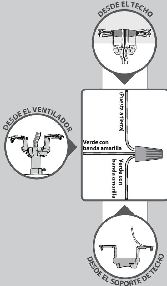
Usando un conector de alambre anaranjado de la bolsa de materiales ★, conecte los 3 alambres de puesta a tierra (verde, verde con banda amarilla, y cobre desnudo) del ventilador, la varilla y el soporte de suspensión.
