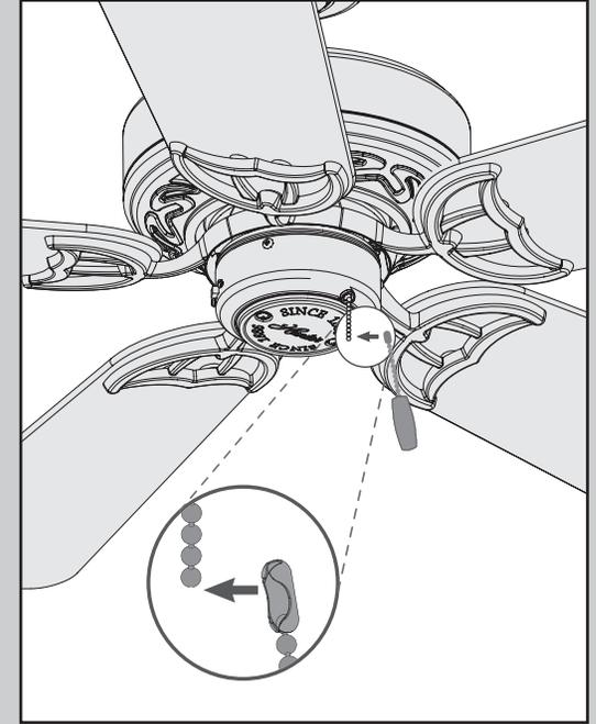
Instalación del pendiente de cadena - Conecte el pendiente de cadena al extremo de la cadena corta que sale de la caja del interruptor.
