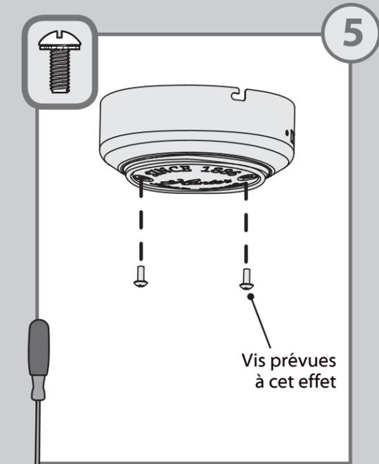
⊗ À l'aide d'un tournevis cruciforme, installez le couvercle sur le boîtier d'interrupteur inférieur en le fixant avec les deux vis prévues à cet effet.
