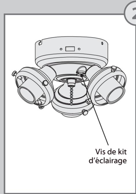
Repérez les deux vis qui fixent le kit d'éclairage au boîtier d'interrupteur inférieur.
