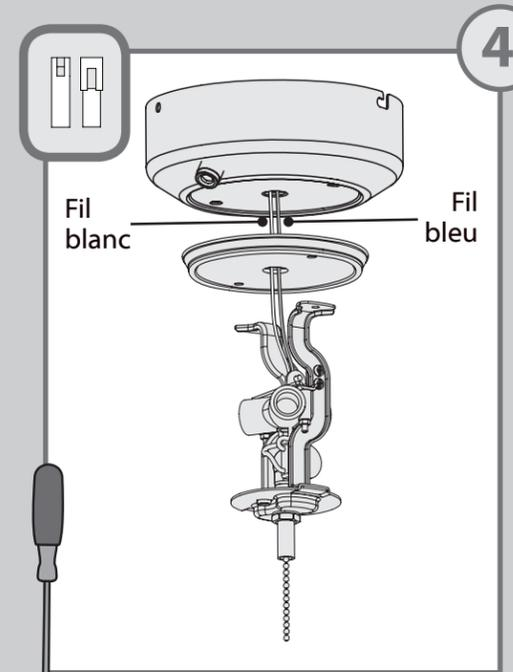
⊗ Séparez les fils bleus reliant le kit d'éclairage au boîtier d'interrupteur inférieur. Séparez les fils blancs reliant le kit d'éclairage au boîtier d'interrupteur inférieur. Installez une borne factice à l'extrémité de chacun des deux fils dans le boîtier d'interrupteur inférieur.
