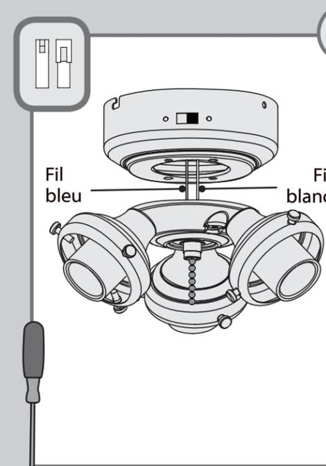
⊗ Séparez les fils bleus reliant le kit d'éclairage au boîtier d'interrupteur inférieur. Séparez les fils blancs reliant le kit d'éclairage au boîtier d'interrupteur inférieur. Installez une borne factice à l'extrémité de chacun des deux fils dans le boîtier d'interrupteur inférieur.
