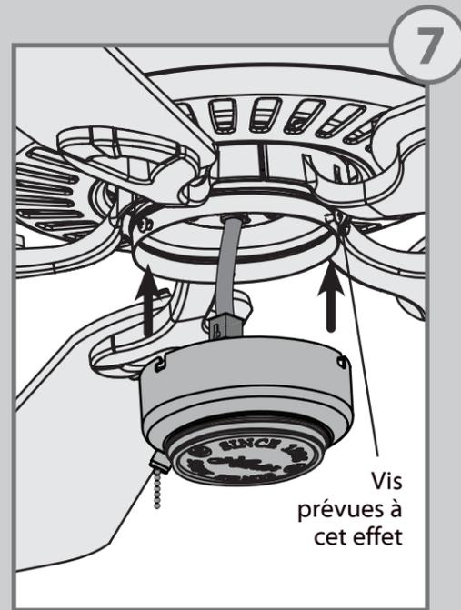
Fixez le boîtier d'interrupteur inférieur au boîtier d'interrupteur supérieur avec les trois vis prévues à cet effet. Serrez les trois vis. **Remarque :** Les boîtiers d'interrupteur ne se fixent pas tous de la même manière. Vérifiez les détails dans votre manuel d'utilisation.
