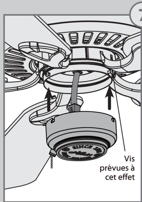
Fixez le boîtier d'interrupteur inférieur au boîtier d'interrupteur supérieur avec les trois vis prévues à cet effet. Serrez les trois vis. **Remarque :** Les boîtiers d'interrupteur ne se fixent pas tous de la même manière. Vérifiez les détails dans votre manuel d'utilisation.
