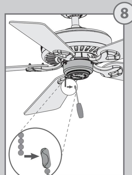
Reliez la chaîne à la chaînette plus courte sortant du boîtier d'interrupteur inférieur.
