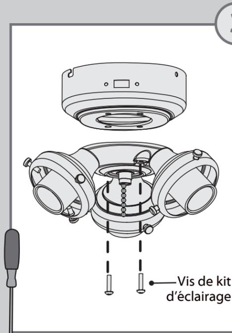
⊗ À l'aide d'un tournevis cruciforme, retirez les deux vis du kit d'éclairage afin de détacher celui-ci du boîtier d'interrupteur inférieur.
