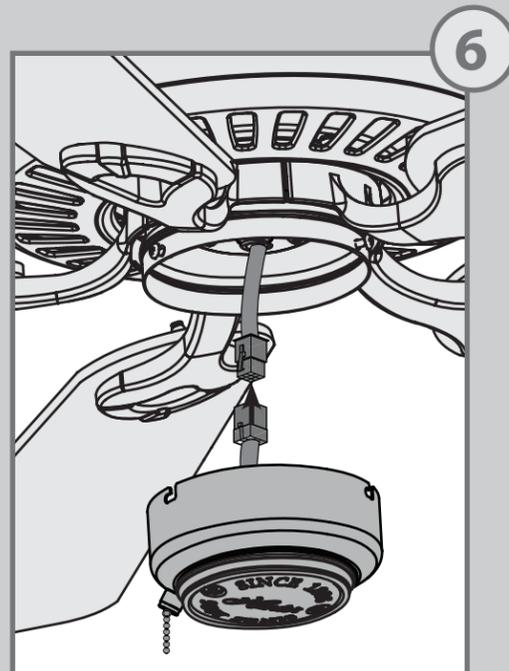
Connecter les connecteurs à fiche des boîtiers d'interrupteur supérieur et inférieur. S'assurer d'aligner les marques colorées sur les connecteurs.
