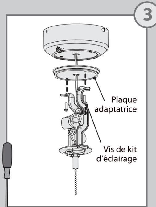
⊗ À l'aide d'un tournevis cruciforme, retirez les deux vis du kit d'éclairage afin de détacher celui-ci de la plaque adaptatrice et du boîtier d'interrupteur.
