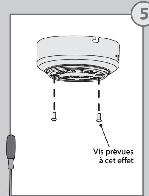
⊗ À l'aide d'un tournevis cruciforme, installez le couvercle sur le boîtier d'interrupteur inférieur en le fixant avec les deux vis prévues à cet effet.
