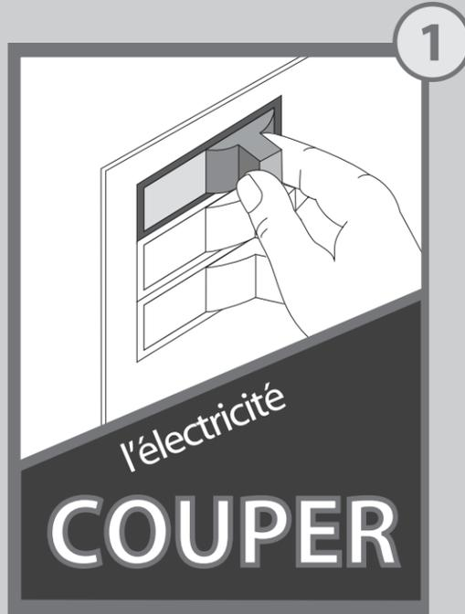
**Mise en garde :** Pour éviter une secousse électrique possible, avant d'installer ou de faire l'entretien du ventilateur, couper le courant aux disjoncteurs de la boîte de sortie et du commutateur mural associé.
