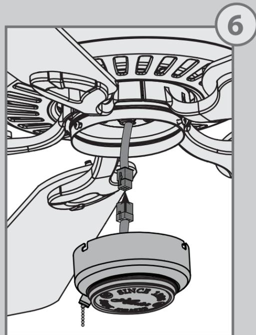
Connecter les connecteurs à fiche des boîtiers d'interrupteur supérieur et inférieur. S'assurer d'aligner les marques colorées sur les connecteurs.
