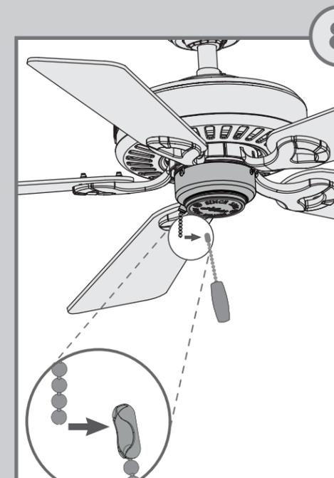
Reliez la chaîne à la chaînette plus courte sortant du boîtier d'interrupteur inférieur.
