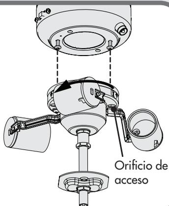
Levante el juego de luz para que coincida con la caja inferior del interruptor. Fije el conjunto de lámparas a la caja del interruptor usando las ranuras de bocalave para enganchar los tornillos del conjunto de lámparas. Gire en sentido de las manecillas. Apriete los tornillos bien ajustados a través de los orificios de acceso.
