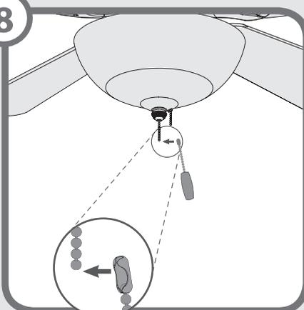
**Instalación del pendiente de cadena** - Conecte el pendiente de cadena al extremo de la cadena corta que sale de la caja del interruptor y del juego de luz. Conecte la alimentación. ¡Ha completado la instalación!
