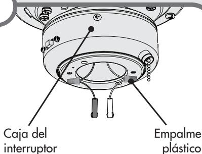
Si su ventilador no posee conectores de pines en los cables provenientes de la caja del interruptor, instale el manido de cables proporcionado. Utilice los conectores de cables proporcionados para conectar el cable blanco del ventilador con el cable blanco del manido de cables y conecte el cable negro o azul del ventilador con el cable negro del manido de cables.
