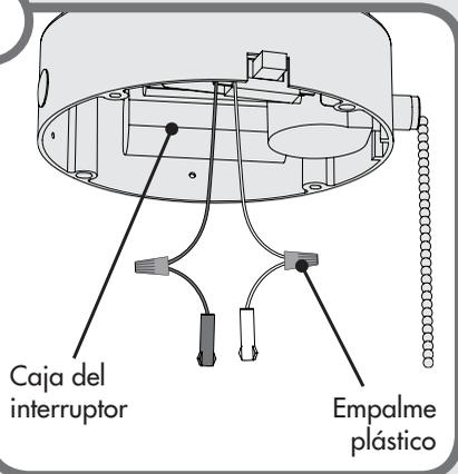
Si su ventilador no posee conectores de pines en los cables provenientes de la caja del interruptor, instale el manajo de cables proporcionado.
