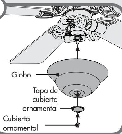
**Instalación de la pantalla (se vende por separado)** - Presione la pantalla del ras de la placa metálica. Pase la cadena de la luz a través del orificio situado en el centro de la tapa de remate y pase la cadena del ventilador a través del orificio situado en el costado de la tapa. Por último, pase únicamente la cadena de la luz a través del orificio situado en el remate y enrosque el remate.
