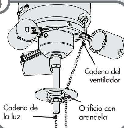
De ser necesario, conecte la extensión de cadena suministrada a la cadena del ventilador que sale de la caja del interruptor. A continuación pase el extremo de la cadena de extensión a través del orificio con arandela situado en el juego de luz.
