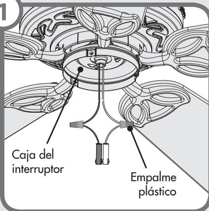
Si su ventilador no posee conectores de pines en los cables provenientes de la caja del interruptor, instale el manejo de cables proporcionado. Utilice los conectores de cables proporcionados para conectar el cable blanco del ventilador con el cable blanco del manejo de cables y conecte el cable negro o azul del ventilador con el cable negro del manejo de cables.
