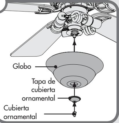
**Instalación de la pantalla (se vende por separado)** - Presione la pantalla del ras de la placa metálica. Pase la cadena de la luz a través del orificio situado en el centro de la tapa de remate y pase la cadena del ventilador a través del orificio situado en el costado de la tapa. Por último, pase únicamente la cadena de la luz a través del orificio situado en el remate y enrosque el remate.
