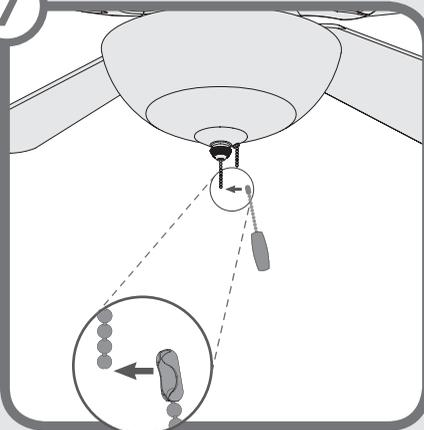
**Instalación del pendiente de cadena** - Conecte los pendientes de cadena a los extremos de las cadenas cortas que salen de la caja del interruptor y del juego de luz. Conecte la alimentación. ¡Ha completado la instalación!
