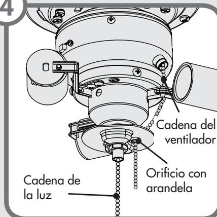
De ser necesario, conecte la extensión de cadena suministrada a la cadena del ventilador que sale de la caja del interruptor. A continuación pase el extremo de la cadena de extensión a través del orificio con arandela situado en el juego de luz.
