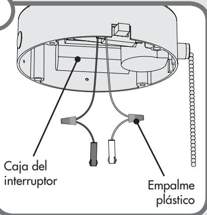
Si su ventilador no posee conectores de pines en los cables provenientes de la caja del interruptor, instale el manajo de cables proporcionado. Utilice los conectores de cables proporcionados para conectar el cable blanco del ventilador con el cable blanco del manajo de cables y conecte el cable negro o azul del ventilador con el cable negro del manajo de cables.
