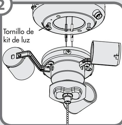
Atornille los dos tornillos del conjunto de lámparas a medio recorrido dentro de la caja del interruptor. Use los conectores de pin individual para conectar el cable negro o azul del ventilador con el cable negro del juego de luz. Conecte el cable blanco del ventilador al cable blanco del juego de luz.
