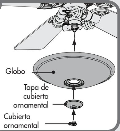
**Instalación de la pantalla** - Presione la pantalla del ras de la placa metálica. Pase la cadena de la luz a través del orificio situado en el centro de la tapa de remate y pase la cadena del ventilador a través del orificio situado en el costado de la tapa. Por último, pase únicamente la cadena de la luz a través del orificio situado en el remate y enrosque el remate.
