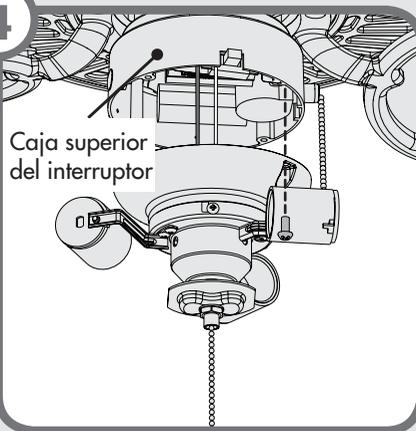
Levante el conjunto del juego de luz de modo que los orificios de los tornillos situados en la caja inferior del interruptor queden alineados con los orificios situados en la caja superior del interruptor. Instale los tornillos de la caja del interruptor y apriételos firmemente.
