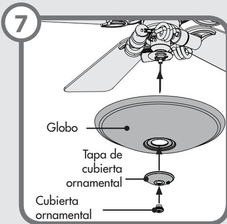
**Instalación de la pantalla** - Presione la pantalla del ras de la placa metálica. Pase la cadena de la luz a través del orificio situado en el centro de la tapa de remate y pase la cadena del ventilador a través del orificio situado en el costado de la tapa. Por último, pase únicamente la cadena de la luz a través del orificio situado en el remate y enrosque el remate.
