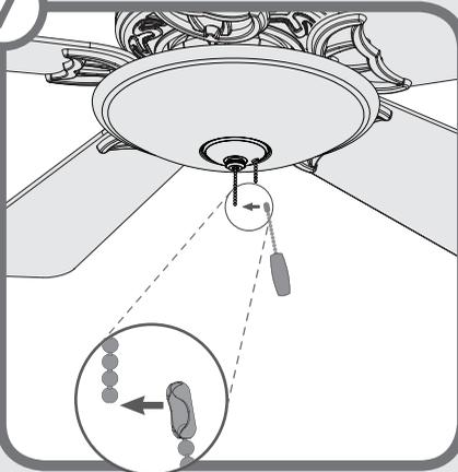
**Instalación del pendiente de cadena** - Conecte los pendientes de cadena a los extremos de las cadenas cortas que salen de la caja del interruptor y del juego de luz. Conecte la alimentación. ¡Ha completado la instalación!
