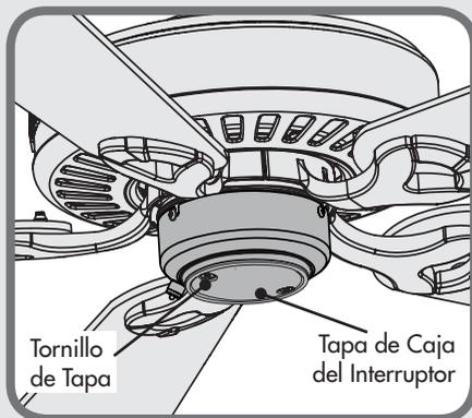
Si la tapa de la caja del interruptor de su ventilador se parece a ésta, quite los tornillos de la tapa con un destornillador estrella (Phillips). A continuación siga las instrucciones de **MONTAJE TIPO A** de las páginas 4-5.
