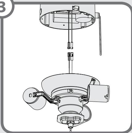
Use los conectores de pin individual para conectar el cable negro o azul del ventilador al cable negro del juego de luz. Conecte el cable blanco del ventilador al cable blanco del juego de luz.
