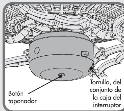
Si la tapa de la caja del interruptor de su ventilador se parece a ésta, quite toda la caja del interruptor; para ello deberá quitar los tornillos de la caja del interruptor con un destornillador estrella (Phillips). Quite el botón de tapón mediante un destornillador estándar. A continuación siga las instrucciones de **MONTAJE TIPO C** de las páginas 8-9.
