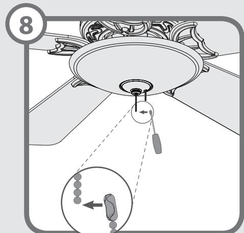
**Instalación del pendiente de cadena** - Conecte el pendiente de cadena al extremo de la cadena corta que sale de la caja del interruptor y del juego de luz. Conecte la alimentación. ¡Ha completado la instalación!
