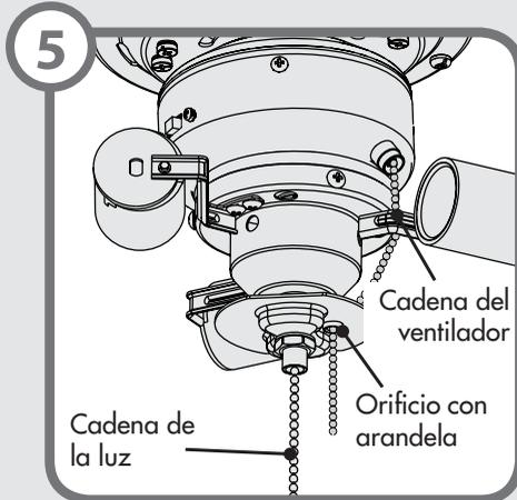
De ser necesario, conecte la extensión de cadena suministrada a la cadena del ventilador que sale de la caja del interruptor. A continuación pase el extremo de la cadena de extensión a través del orificio con arandela situado en el juego de luz.
