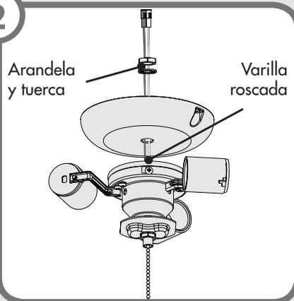
Pase los cables a través de la tapa de la caja del interruptor, de la arandela y de la tuerca. A continuación instale la tapa de la caja del interruptor haciéndola girar en sentido horario en la varilla roscada. Instale la arandela y la tuerca en la varilla roscada y apriete firmemente.
