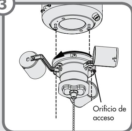
Levante el juego de luz para que coincida con la caja inferior del interruptor. Fije el conjunto de lámparas a la caja del interruptor usando las ranuras de bocallave para enganchar los tornillos del conjunto de lámparas. Gire en sentido de las manecillas. Apriete los tornillos bien ajustados a través de los orificios de acceso.
