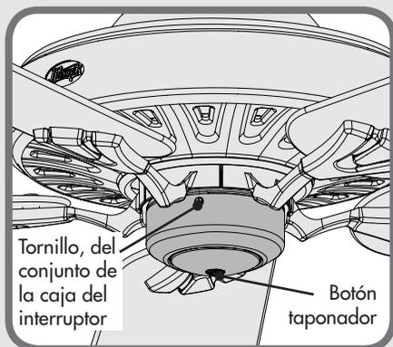
Si la tapa de la caja del interruptor de su ventilador se parece a ésta, quite toda la caja del interruptor; para ello deberá quitar los tornillos de la caja del interruptor con un destornillador estrella (Phillips). Quite el botón de tapón. A continuación siga las instrucciones de **MONTAJE TIPO B** de las páginas 6-7.
