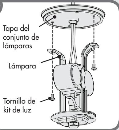
Instale los tornillos cortos del conjunto de lámparas, encontrado en la bolsa de herrajes, a través de la lámpara y hacia la tapa del conjunto de lámparas.
