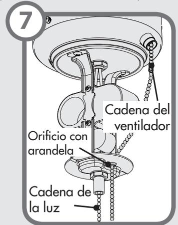
De ser necesario, conecte la extensión de cadena suministrada a la cadena del ventilador que sale de la caja del interruptor. A continuación pase el extremo de la cadena de extensión a través del orificio con arandela situado en el juego de luz.
