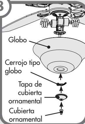
**Instalación de la pantalla** - Presione la pantalla y el retén de pantalla del ras de la placa metálica. Pase la cadena de la luz a través del orificio situado en el centro de la tapa de remate y pase la cadena del ventilador a través del orificio situado en el costado de la tapa. Por último, pase únicamente la cadena de la luz a través del orificio situado en el remate y enrosque el remate.
