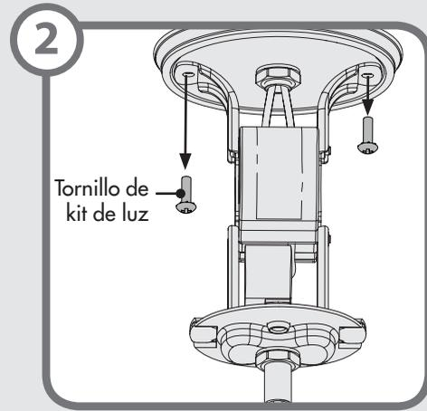
Retire los tornillos del conjunto de lámparas que sujetan la tapa del conjunto de lámparas a la lámpara.
