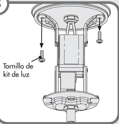
Retire los tornillos del conjunto de lámparas que sujetan la tapa del conjunto de lámparas a la lámpara.
