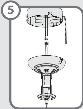
Use los conectores de pin individual para conectar el cable negro o azul del ventilador al cable negro del juego de luz. Conecte el cable blanco del ventilador al cable blanco del juego de luz.
