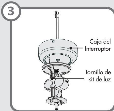
Pase los cables del juego de luz a través del orificio central situado en la caja del interruptor. A continuación fije la caja del interruptor al juego de luz; para ello instale los tornillos del juego de luz en la parte inferior de la caja del interruptor.
