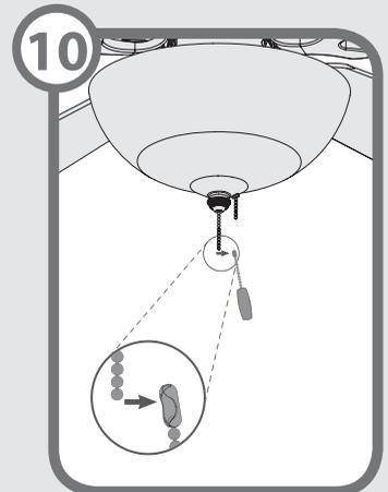
**Instalación del pendiente de cadena** - Conecte el pendiente de cadena al extremo de la cadena corta que sale de la caja del interruptor y del juego de luz. Conecte la alimentación. ¡Ha completado la instalación!
