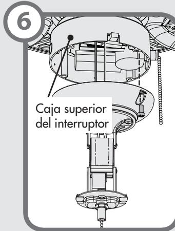
Levante el conjunto del juego de luz de modo que los orificios de los tornillos situados en la caja inferior del interruptor queden alineados con los orificios situados en la caja superior del interruptor. Instale los tornillos de la caja del interruptor y apríetelos firmemente.
