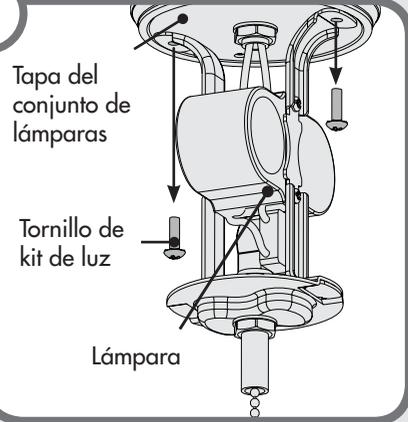
Retire los tornillos que sujetan la tapa del conjunto de lámparas a la lámpara. Deseche los tornillos.
