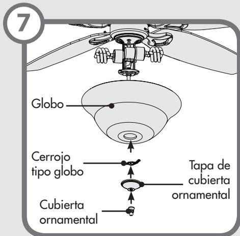
**Instalación de la pantalla** - Presione la pantalla y el retén de pantalla del ras de la placa metálica. Pase la cadena de la luz a través del orificio situado en el centro de la tapa de remate y pase la cadena del ventilador a través del orificio situado en el costado de la tapa. Por último, pase únicamente la cadena de la luz a través del orificio situado en el remate y enrosque el remate.
