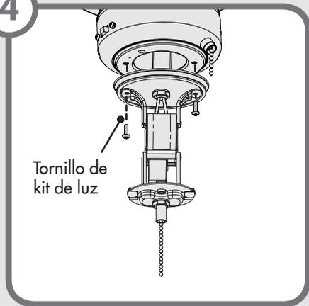
Sujete el conjunto de lámparas a la caja del interruptor, re-instalando los tornillos del conjunto de lámparas a través de la lámpara y de la tapa del conjunto de lámparas, y dentro de la caja del interruptor.
