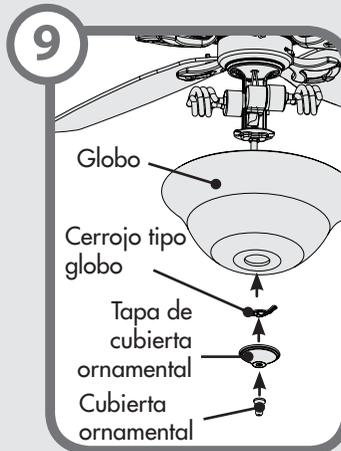
**Instalación de la pantalla** - Presione la pantalla y el retén de pantalla del ras de la placa metálica. Pase la cadena de la luz a través del orificio situado en el centro de la tapa de remate y pase la cadena del ventilador a través del orificio situado en el costado de la tapa. Por último, pase únicamente la cadena de la luz a través del orificio situado en el remate y enrosque el remate.
