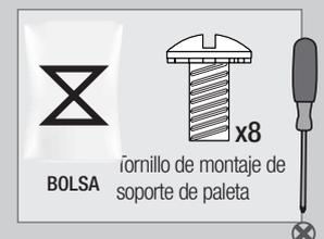
Acople sin emplear mucha fuerza los soportes de paleta al motor con los tornillos de la bolsa de materiales X, luego apriete con firmeza, cuando ambos tornillos estén acoplados.
