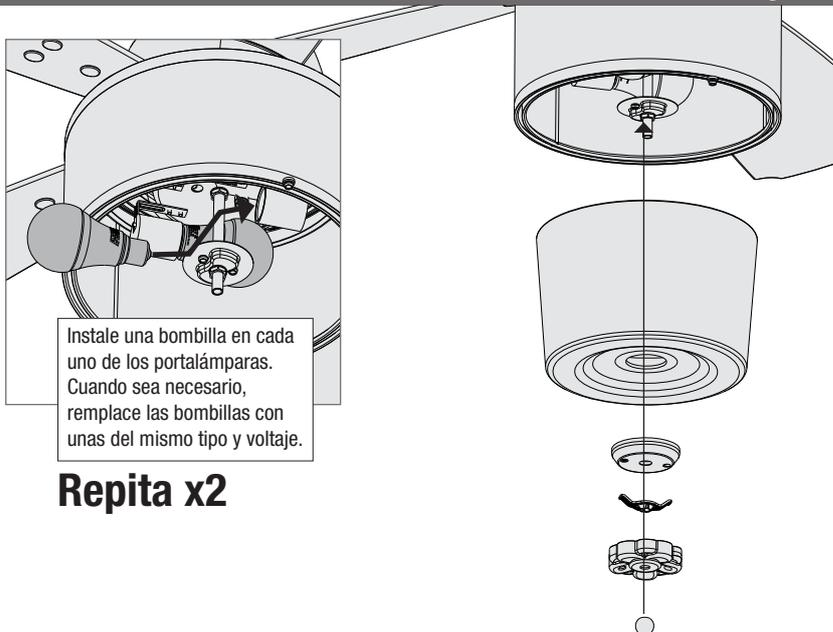
Presione la pantalla y el cerrojo tipo globo al ras de la placa metálica. Pase la cadena de la luz a través del orificio situado en el centro de la tapa de cubierta ornamental y pase la cadena del ventilador a través del orificio situado en el costado de la tapa. Finalmente pase únicamente la cadena de la luz a través del orificio situado en la cubierta ornamental y enrosque la cubierta ornamental en la varilla roscada.
