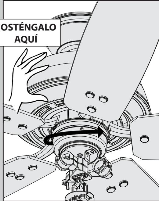
**Mantenga el cuerpo del ventilador fijo** y rote el artefacto de iluminación en el sentido de las manecillas del reloj para engranar el pin de cierre.
