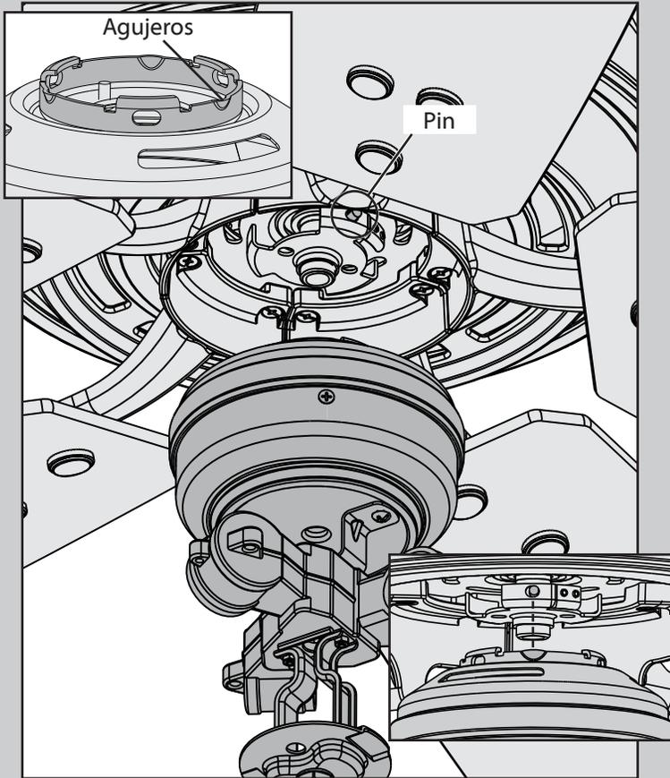
Levante el artefacto de iluminación a la parte inferior del ventilador. Alinear las agujeros del aro de montaje en la parte superior del artefacto de iluminación con el montaje en la parte inferior del ventilador.
