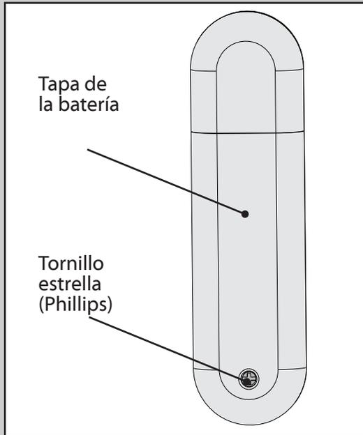
Para acceder al compartimento de la batería quite el pequeño tornillo estrella (Phillips) que fija la tapa del compartimento al conjunto del transmisor. La batería debe instalarse con el lado positivo (+) hacia arriba. Reemplace la batería CR2032 según sea necesario.
