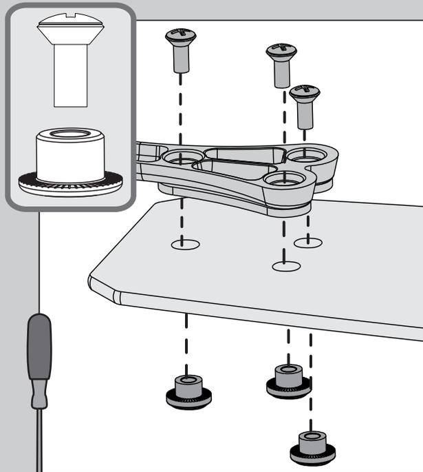
Asegure cada una de las aspas al soporte del asa como se muestra usando las tuercas para el asa que se encuentran en la **■** bolsa de herrajes, y los tornillos del ensamble del asa, que se encuentran en la **▲** bolsa de herrajes.
