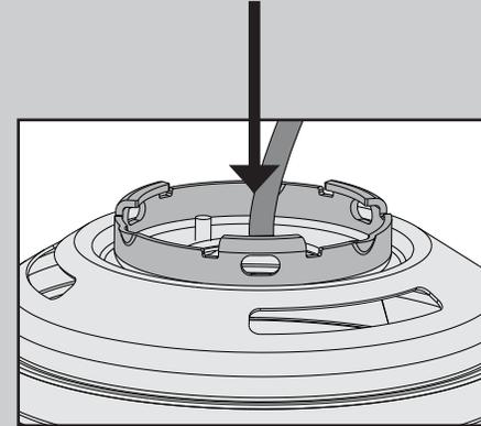
Empuje **el conector y el exceso de alambre** dentro del agujero en la parte superior del artefacto de iluminación.
