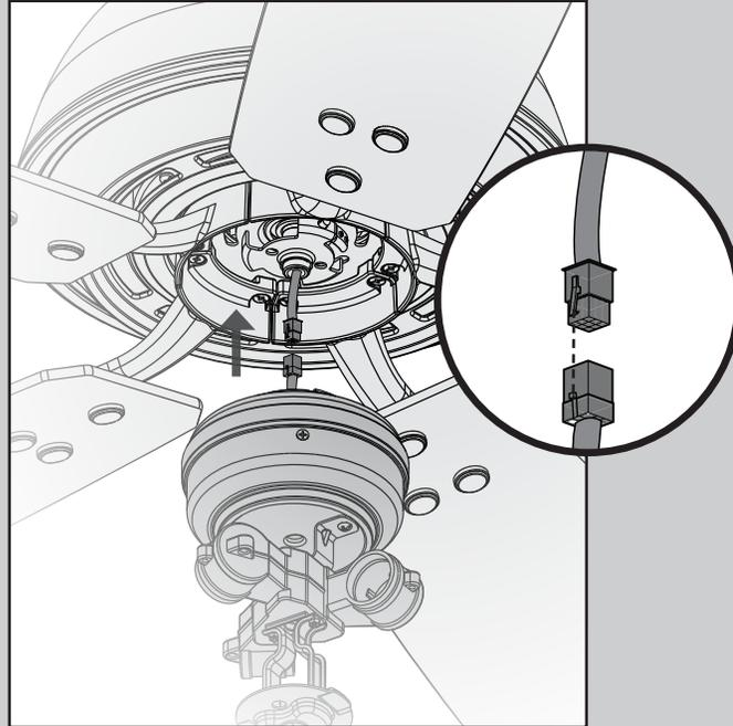
Conecte los enchufes del ventilador y de la lámpara. Cerciérese de alinear las marcas en color con los conectores y que éstos estén atados juntos.
