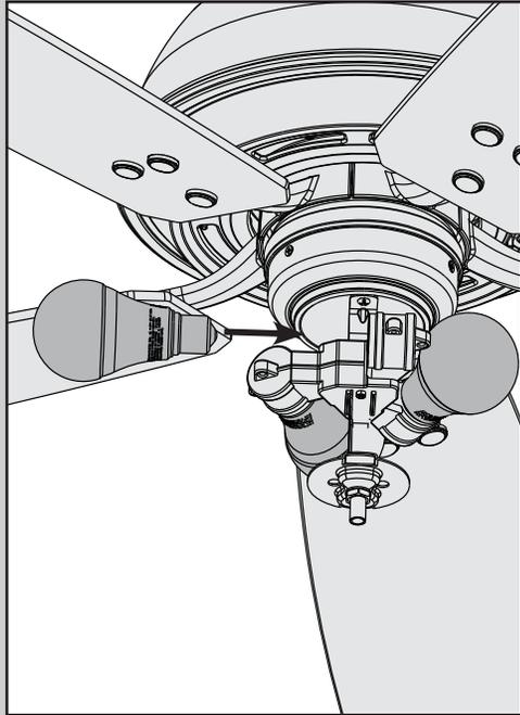
Instale las bombillas LED incluidas en los portalámparas. Cuando sea necesario, reemplace las bombillas con unas de la misma potencia.
