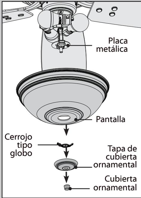
**Para cambiar las bombillas,** desenrosque la cubierta ornamental y retírela de la varilla roscada. Quite la tapa de la cubierta ornamental y desenrosque el cerrojo tipo globo mientras sostiene la pantalla con la otra mano. Quite cuidadosamente la pantalla. Desenrosque las bombillas y reemplácelas por bombillas del mismo tipo y voltaje. Reinstale el conjunto de pantalla.
