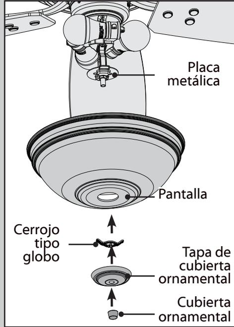
Presione la pantalla y el cerrojo tipo globo al ras de la placa metálica. Pase la cadena de la luz a través del orificio situado en el centro de la tapa de cubierta ornamental y pase la cadena del ventilador a través del orificio situado en el costado de la tapa. Finalmente pase únicamente la cadena de la luz a través del orificio situado en la cubierta ornamental y enrosque la cubierta ornamental en la varilla roscada.
