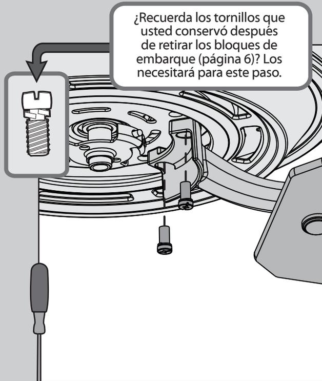
¿Recuerda los tornillos que usted conservó después de retirar los bloques de embarque (página 6)? Los necesitará para este paso.
