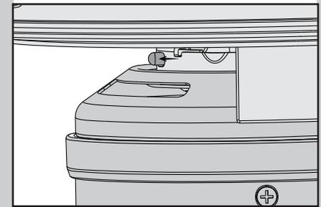
De la lámpara un giro suave en contra de las manecillas del reloj para asegurar que ésta esté segura y que el perno de cierre haya enganchado.
