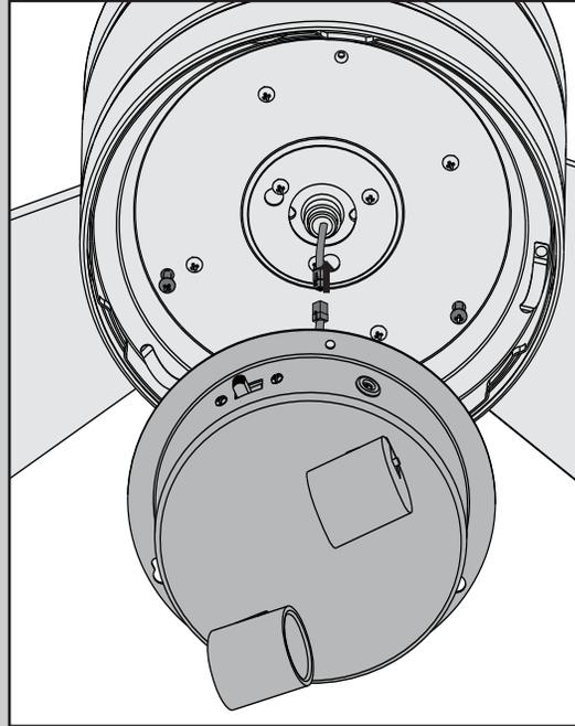
Asegúrese de que todos los cables del ventilador y del conjunto de lámparas estén ajustados dentro del centro del conjunto de lámparas, y que no estén atascados entre la caja superior del interruptor y el conjunto de lámparas o colgando de los lados.
