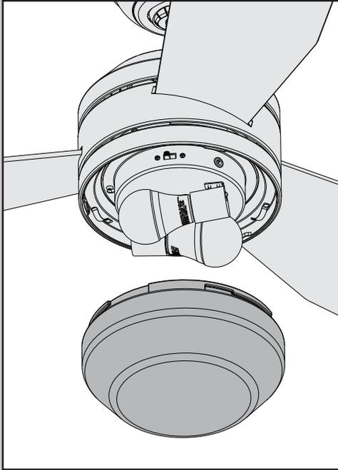
**Para cambiar las bombillas,** quite cuidadosamente la pantalla. Desenrosque las bombillas y reemplácelas por bombillas del mismo tipo y voltaje. Reinstale el conjunto de pantalla.
