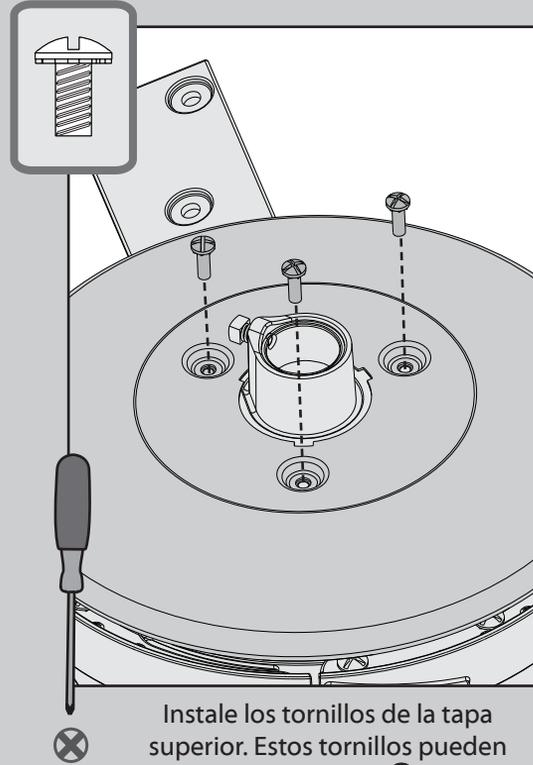
Instale los tornillos de la tapa superior. Estos tornillos pueden ser encontrados en la ● bolsa de materiales.
