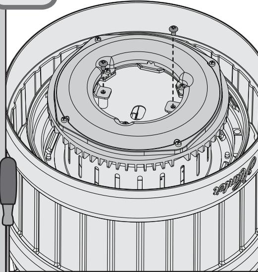
⊗ Sujete el conjunto de lámpara LED utilizando los tornillos para conjunto de lámpara LED encontrados en la bolsa de herrajes ≡.
