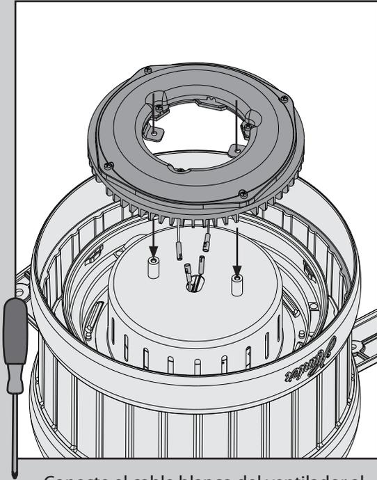
⊗ Conecte el cable blanco del ventilador al cable blanco del conjunto de luz. Luego, conecte el cable azul del ventilador al cable negro del conjunto de luz. Baje el conjunto de luces LED hasta los postes de la caja.
