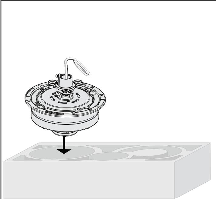
Colóquelo el conjunto del motor en uno de los orificios en el empaque.
