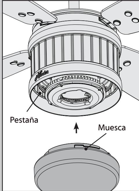
Ubique las muescas del borde externo de la pantalla de vidrio de modo que se alineen con las pestañas en la superficie interna del borde del artefacto de iluminación.
