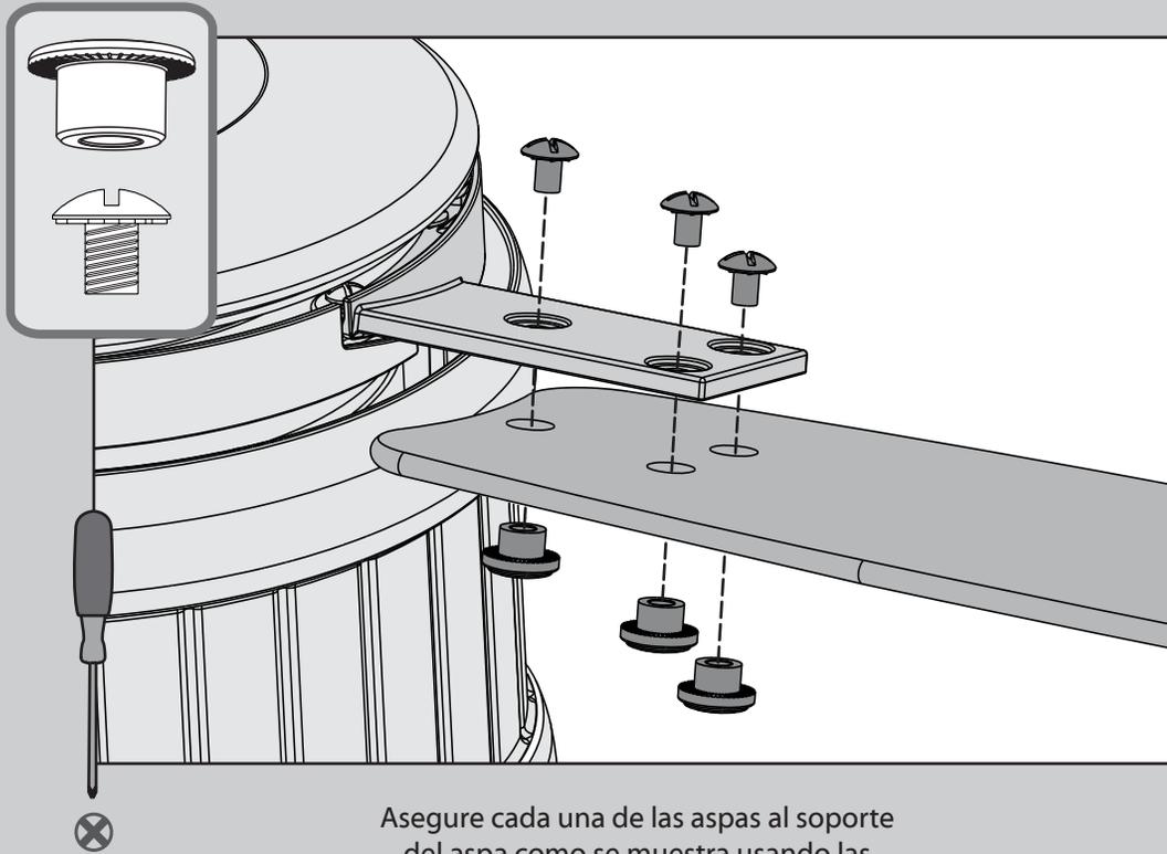
Asegure cada una de las aspas al soporte del aspa como se muestra usando las tuercas para el aspa que se encuentran en la ■ bolsa de herrajes, y los tornillos del ensamble del aspa, que se encuentran en la ▲ bolsa de herrajes.
