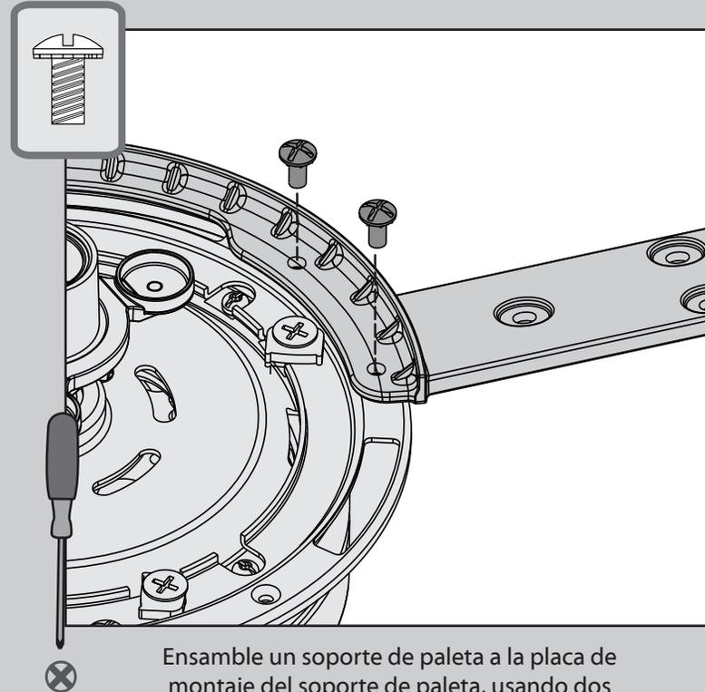
Ensamble un soporte de paleta a la placa de montaje del soporte de paleta, usando dos tornillos para ensamble de soporte de paleta que se encuentran en la
