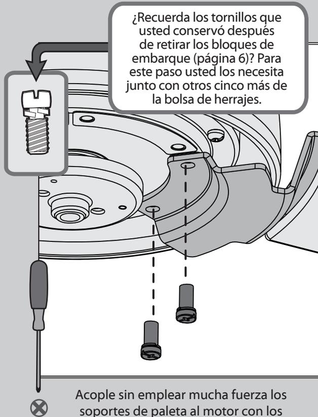
¿Recuerda los tornillos que usted conservó después de retirar los bloques de embarque (página 6)? Para este paso usted los necesita junto con otros cinco más de la bolsa de herrajes.
