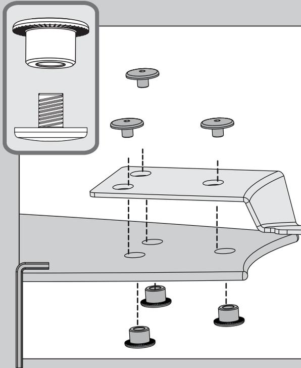
Usando la llave Allen incluida, asegure cada una de las aspas al soporte del asa como se muestra usando las tuercas para el asa que se encuentran en la ■ bolsa de herrajes, y los tornillos del ensamble del asa, que se encuentran en la ▲ bolsa de herrajes.
