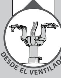
Gire los empalmes hacia arriba y presiónelos cuidadosamente hacia atrás a través del soporte de suspensión dentro de la caja de salida. Separe los alambres, con los alambres puestos a tierra a un lado de la caja de salida y los alambres no puestos a tierra al otro lado de la caja de salida.
