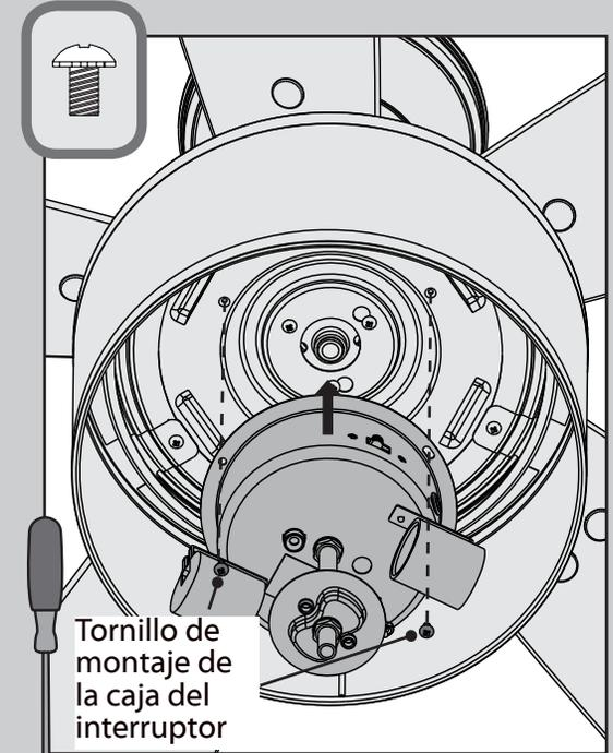
Tornillo de montaje de la caja del interruptor
