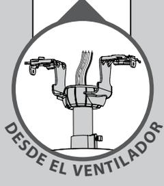
Gire los empalmes hacia arriba y presiónelos cuidadosamente hacia atrás a través del soporte de suspensión dentro de la caja de salida. Separe los alambres, con los alambres puestos a tierra a un lado de la caja de salida y los alambres no puestos a tierra al otro lado de la caja de salida.
