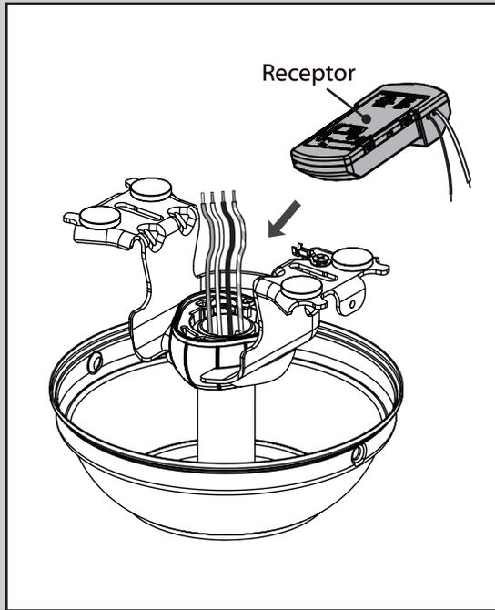
Coloque el receptor en la parte superior del conjunto del tubo vertical como se muestra.
