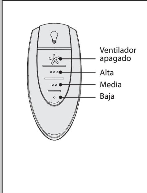
El botón de desconexión del ventilador solo apaga el ventilador. Para encender el ventilador debe presionar uno de los botones de velocidad.
