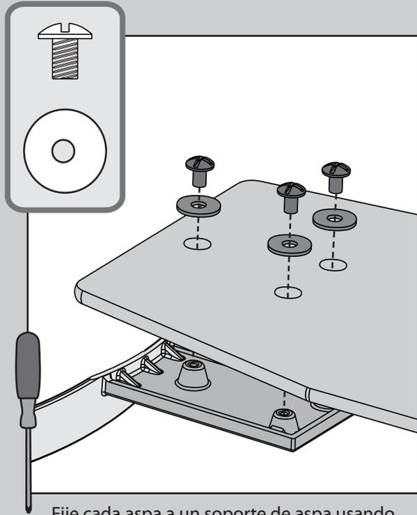
⊗ Fije cada aspa a un soporte de aspa usando cuatro arandelas, que están en la bolsa ■, de aspa y cuatro tornillos de montaje de aspa, que están en la bolsa ▲.
