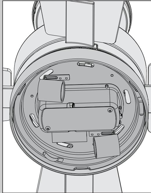
Alinee las ranuras de bocallave en el conjunto de luz con los tornillos de montaje. Asegúrese de que todos los alambres del ventilador y del conjunto de luz estén ajustados dentro del centro del conjunto de luz, y que no estén atascados entre la caja superior del interruptor y el conjunto de luz o colgando de los lados.
