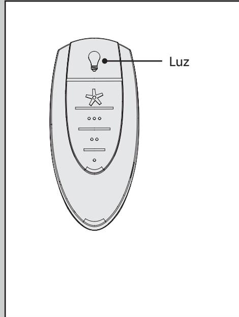
Presione brevemente el botón de luz para encender y apagar las luces. Mantenga el botón de luz presionado para aumentar o disminuir la intensidad lumínica.
