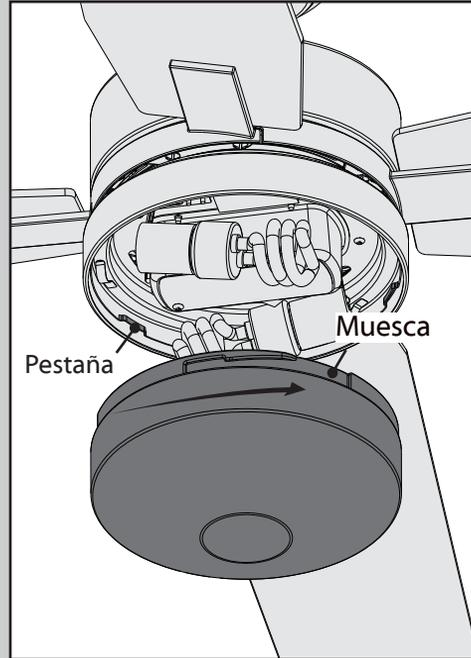
Ubique las muescas del borde externo de la pantalla de vidrio de modo que se alineen con las pestañas en la superficie interna del borde del artefacto de iluminación. Levante cuidadosamente la pantalla dentro del artefacto de iluminación tanto como sea posible. Gire la pantalla en sentido horario hasta que esté sujeta firmemente.
