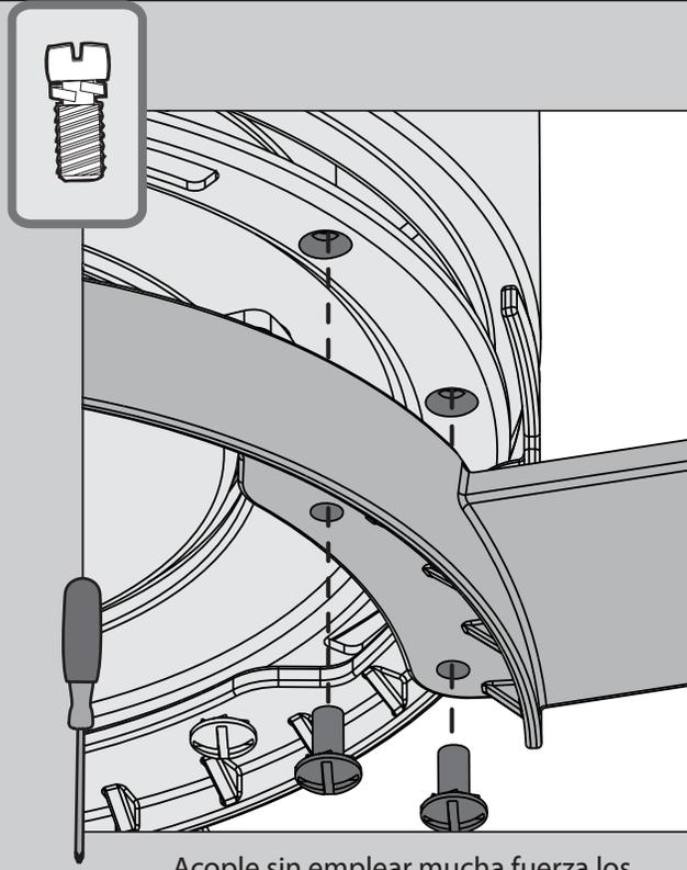
⊗ Acople sin emplear mucha fuerza los soportes de paleta al motor con los tornillos de la bolsa de materiales ☒, luego apriete con firmeza, cuando ambos tornillos estén acoplados.
