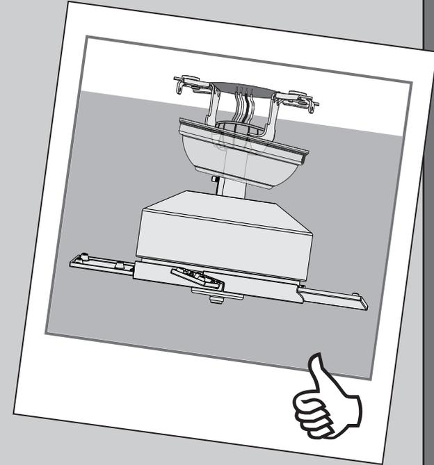
**Nota:** Para conectar los alambres, sostenga los extremos desnudos de los alambres juntos y coloque un conector sobre ellos; luego tuerza en el sentido horario hasta que queden apretados.
