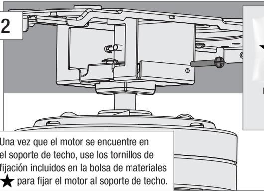
Una vez que el motor se encuentre en el soporte de techo, use los tornillos de fijación incluidos en la bolsa de materiales ★ para fijar el motor al soporte de techo.
