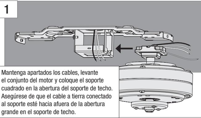
Mantenga apartados los cables, levante el conjunto del motor y coloque el soporte cuadrado en la abertura del soporte de techo. Asegúrese de que el cable a tierra conectado al soporte esté hacia afuera de la abertura grande en el soporte de techo.
