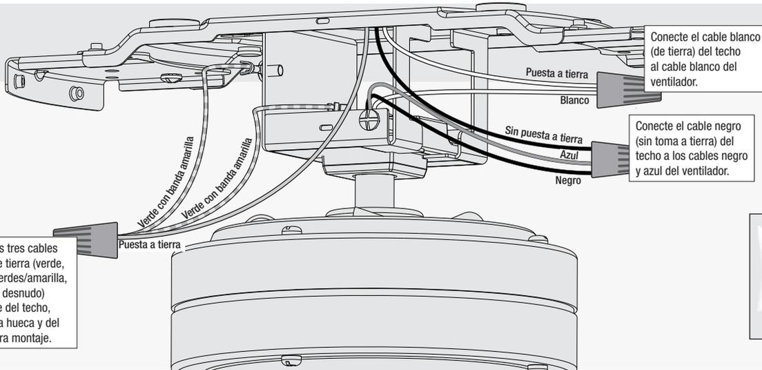
Conecte los tres cables de toma de tierra (verde, con raya verdes/amarilla, o de cobre desnudo) procedente del techo, de la varilla hueca y del soporte para montaje.
