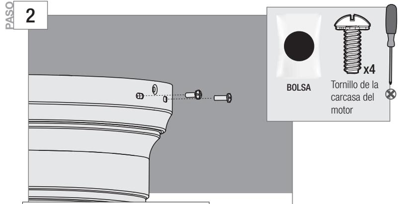
Utilice un destornillador Phillips para montar los cuatro tornillos del alojamiento del motor incluidos en la bolsa de materiales. ● Apriete firmemente los cuatro tornillos.
