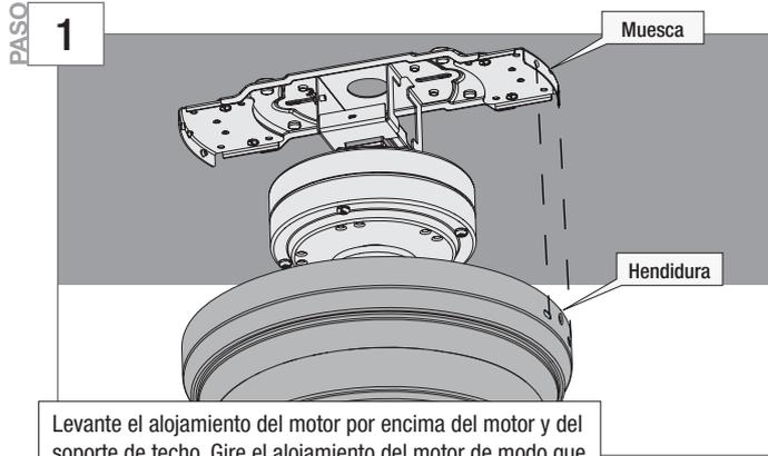
Levante el alojamiento del motor por encima del motor y del soporte de techo. Gire el alojamiento del motor de modo que los orificios de los tornillos queden alineados y la hendidura en las trabas del alojamiento queden en posición con la muesca situada en el soporte de techo. **El alojamiento del motor no está asegurado hasta que no se completa el paso siguiente. No lo deje sin supervisión.**
