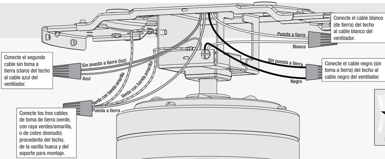
Conecte el segundo cable sin toma a tierra (claro) del techo al cable azul del ventilador.
