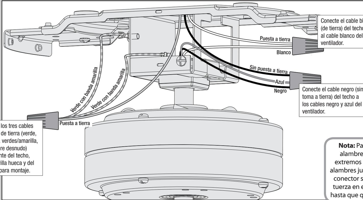
Conecte los tres cables de toma de tierra (verde, con raya verdes/amarilla, o de cobre desnudo) procedente del techo, de la varilla hueca y del soporte para montaje.
