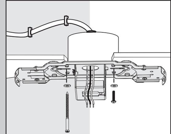
**Use tornillo para madera de 3"** (incluido) para asegurar a la estructura de soporte con la caja de salida eléctrica aprobada. Taladre agujeros piloto de 9/64" en la estructura de soporte para ayudar a asegurar el soporte de techo con los materiales de la bolsa ★.
