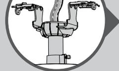
Usando un conector de alambre anaranjado de la bolsa de materiales ★, conecte los 3 alambres de puesta a tierra (verde, verde con banda amarilla, y cobre desnudo) del ventilador, la varilla y el soporte de suspensión.
