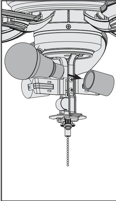
Instale las bombillas LED incluidas en los portalámparas. Cuando sea necesario, remplace las bombillas con unas de la misma potencia.
