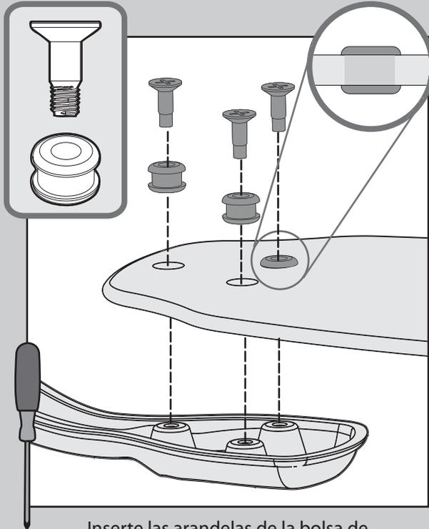
⊗ Inserte las arandelas de la bolsa de materiales ■ en los agujeros de las paletas, luego asegure cada paleta a un soporte de paleta con los tornillos de la bolsa de materiales ▲.
