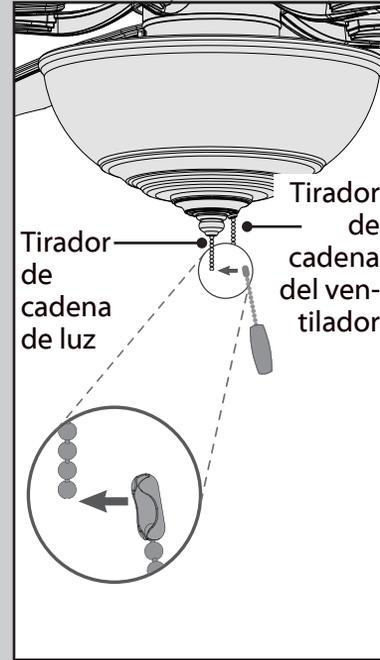
Coloque el pendiente de cadena adecuado en cada una de las cadenas cortas que salen de la cubierta ornamental y de la tapa de la cubierta ornamental. El tirador de cadena del ventilador controla la velocidad: de velocidad alta a apagado. El tirador de cadena de luz controla el accesorio de luz: encendido y apagado.
