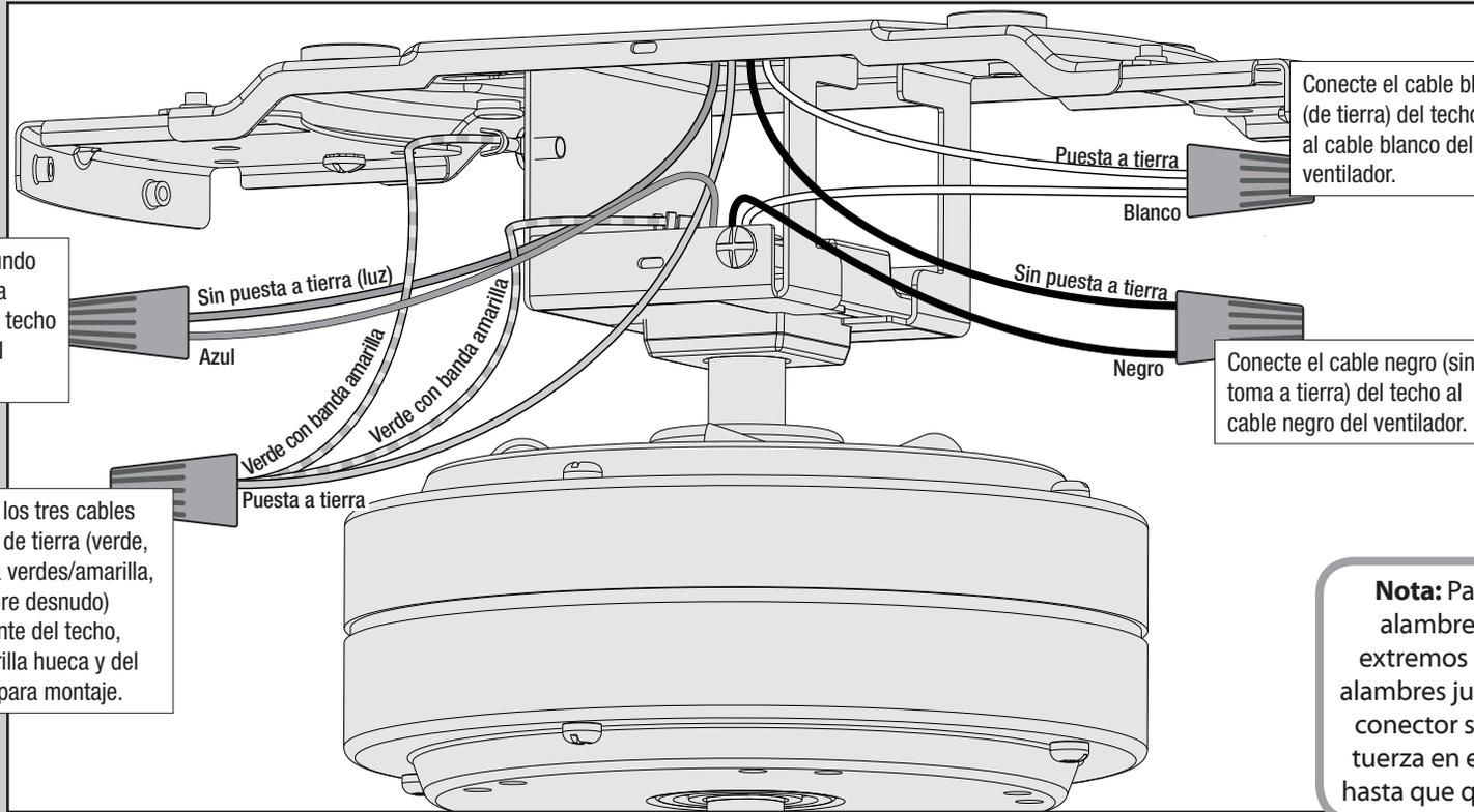
Conecte el segundo cable sin toma a tierra (claro) del techo al cable azul del ventilador.
