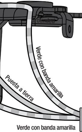
**Nota:** Para conectar los alambres, sostenga los extremos desnudos de los alambres juntos y coloque un conector sobre ellos; luego tuerza en el sentido horario hasta que queden apretados.
