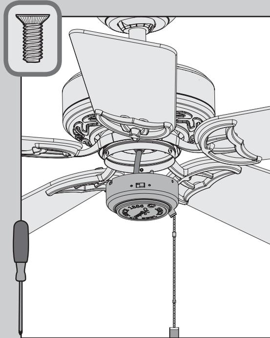
⊗ Levante la caja inferior del interruptor hasta que sus orificios para tornillos estén alineados con los orificios para tornillos en la caja superior del interruptor. Instale los tres tornillos de la caja del interruptor, que se encuentran en la bolsa de materiales
