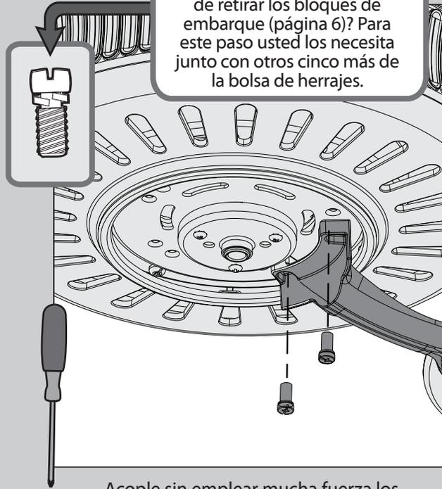
⊗ Acople sin emplear mucha fuerza los soportes de paleta al motor con los tornillos de la bolsa de materiales ⊗, luego apriete con firmeza, cuando ambos tornillos estén acoplados.
