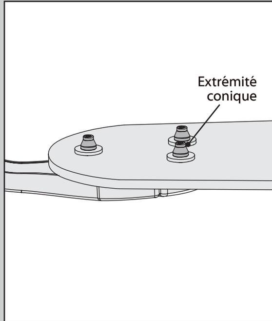
Les extrémités coniques des montants du support de pale resteront visibles au-dessus de la pale si le montage est réalisé correctement.
