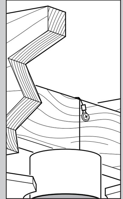
Serrer la boucle et serrer la vis et la rondelle jusqu'en bas de l'entretoise. Enrouler l'excédent de câble.
