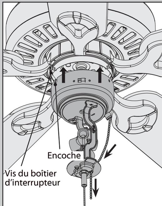
Aligner les encoches dans les côtés du boîtier d'interrupteur inférieur avec les vis du boîtier d'interrupteur supérieur. Faire tourner le boîtier d'interrupteur inférieur dans le sens horaire pour le bloquer en place. Faites ensuite passer la chaînette du ventilateur dans le trou du kit d'éclairage.
