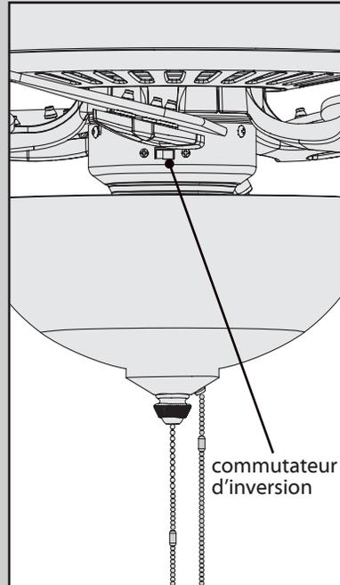
**Pour inverser la direction du courant d'air,** déplacer le commutateur d'inversion dans la position opposée.
