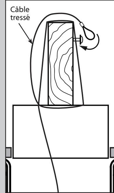
Enrouler le câble tressé en une boucle complète autour de l'entretoise. Accrocher l'extrémité en boucle du câble à la vis à bois de façon à ce que celui-ci se trouve entre la rondelle et l'entretoise.
