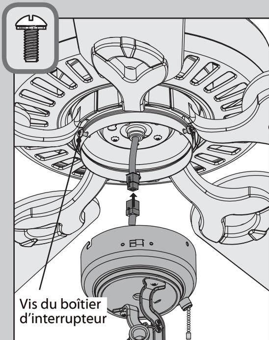
Installer partiellement deux des vis du boîtier d'interrupteur (qui se trouvent dans le sac de matériel ☰). Connecter les connecteurs à fiche des boîtiers d'interrupteur supérieur et inférieur. S'assurer d'aligner les marques colorées sur les connecteurs.
