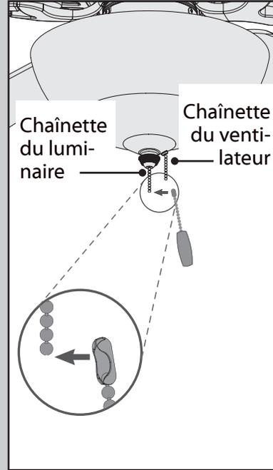
Reliez la chaînette appropriée aux chaînettes plus courtes sortant du faîteau et de sa rondelle. La chaînette de ventilateur contrôle la vitesse : de rapide à la mise à l'arrêt. La chaînette du luminaire contrôle celui-ci : marche et arrêt.
