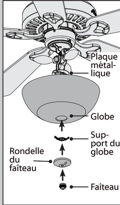
Appuyez sur le globe et sur son support pour les fixer contre la plaque métallique. Faites passer la chaînette de l'éclairage dans le trou situé au centre de la rondelle du faîteau, tandis que la chaînette du ventilateur doit passer dans le trou situé sur le côté de la rondelle. Enfin, faites passer uniquement la chaînette d'éclairage dans le trou du faîteau, puis vissez celui-ci sur la tige filetée.
