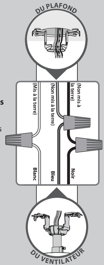
Tourner les jonctions de fils vers le haut et les pousser avec précaution par la plaque de suspension dans la boîte de raccordement. Séparer les fils, les fils mis à la terre d'un côté de la boîte de raccordement et les fils non mis à la terre de l'autre côté.
