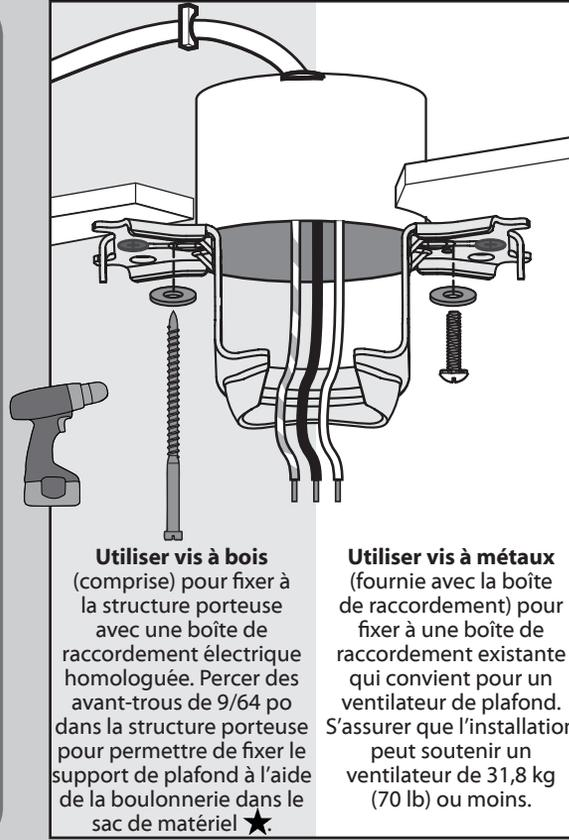
**Utiliser vis à bois** (comprise) pour fixer à la structure porteuse avec une boîte de raccordement électrique homologuée. Percer des avant-trous de 9/64 po dans la structure porteuse pour permettre de fixer le support de plafond à l'aide de la boulonnerie dans le sac de matériel ★.
