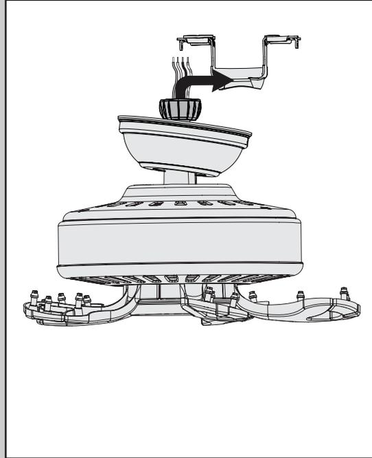
**NE PAS SOULEVER LE VENTILATEUR PAR LE PAVILLON OU LES FILS.** Placer la boule de la tige de suspension dans l'encoche dans le support de plafond.
