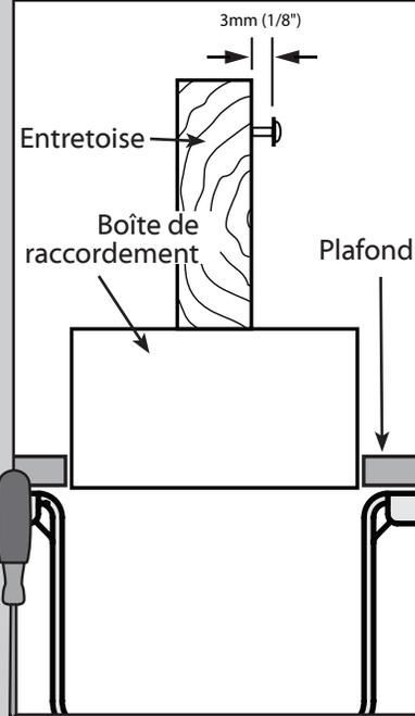
⊗ Enfoncer la vis à bois et la rondelle (qui se trouve dans le sac de matériel 🍁) dans le côté de l'entretoise qui soutient la boîte de raccordement. Laisser un espace de 3 mm entre l'entretoise et la rondelle.
