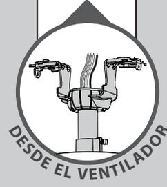
Usando un conector de alambre anaranjado de la bolsa de materiales ★, conecte los 3 alambres de puesta a tierra (verde, verde con banda amarilla, y cobre desnudo) del ventilador, la varilla y el soporte de suspensión.
