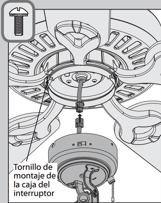
Instale parcialmente dos de los tornillos de las cajas del interruptor que están en la bolsa . Conecte las clavijas de las cajas superior e inferior del interruptor. Asegúrese de alinear las marcas de color de los conectores.
