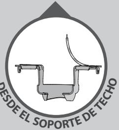
Gire los empalmes hacia arriba y presiónelos cuidadosamente hacia atrás a través del soporte de suspensión dentro de la caja de salida. Separe los alambres, con los alambres puestos a tierra a un lado de la caja de salida y los alambres no puestos a tierra al otro lado de la caja de salida.
