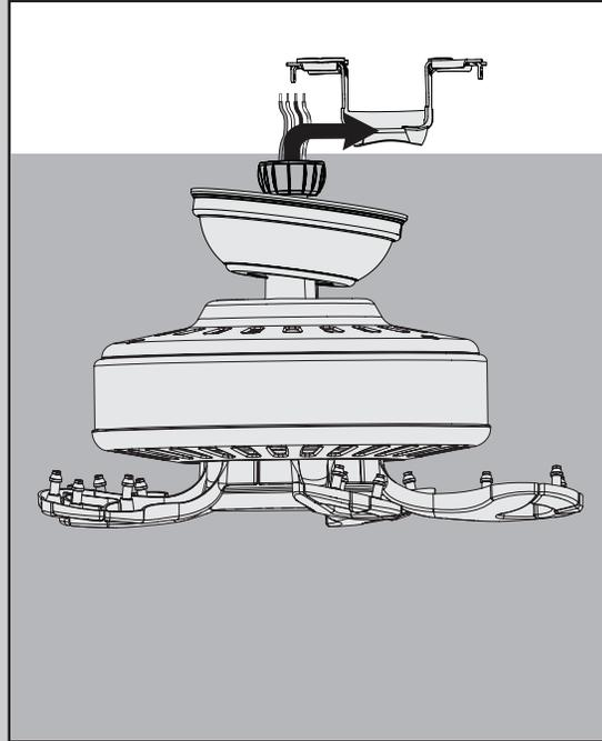
**NO LEVANTE EL VENTILADOR AGARRANDO LA CAMPANA O LOS CABLES.** Coloque la bola de la varilla en la ranura del soporte de techo.
