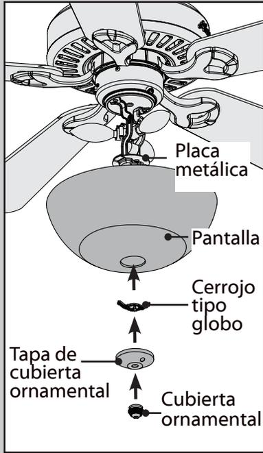
**Para cambiar las bombillas,** desenrosque la cubierta ornamental y retírela de la varilla roscada. Quite la tapa de la cubierta ornamental y desenrosque el cerrojo tipo globo mientras sostiene la pantalla con la otra mano. Quite cuidadosamente la pantalla. Desenrosque las bombillas y reemplácelas por bombillas del mismo tipo y voltaje. Reinstale el conjunto de pantalla.
