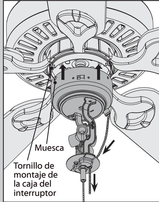
Alinee las muescas en los lados de la caja inferior del interruptor con los tornillos en la caja superior del interruptor. Gire la caja inferior del interruptor en sentido horario para asegurar los tornillos en su lugar. A continuación pase la cadena del ventilador a través del orificio situado en el conjunto de la luz.
