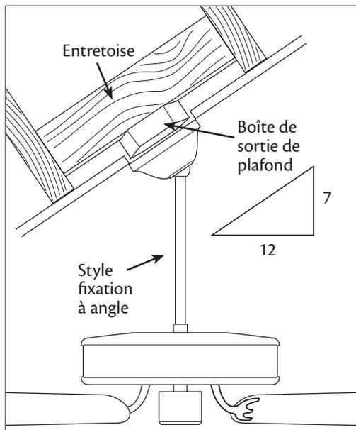
**Fixation à angle** recommandée pour un plafond en voûte ou incliné
