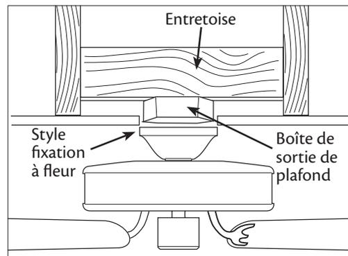
**La fixation à fleur** se fait à ras du plafond et est recommandée pour les plafonds d'une hauteur inférieure à 2,4 m (8 pi)
