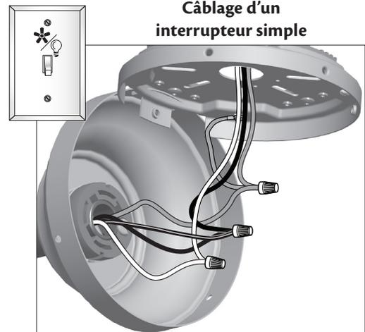
Câblage d'un interrupteur simple
