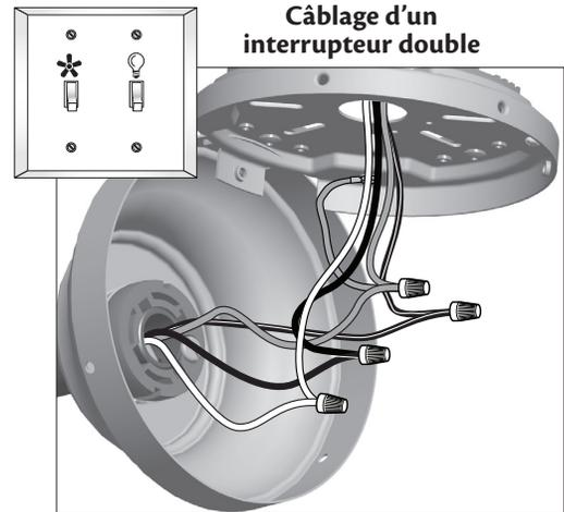
Câblage d'un interrupteur double
