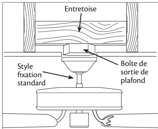
**La fixation standard** fixe le ventilateur au plafond par une tige de suspension (comprise).
