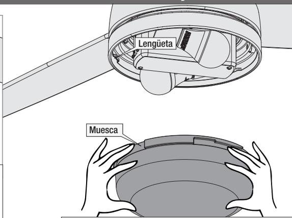
Levante la pantalla y alinee las muescas en la pantalla de vidrio con las lengüetas en el conjunto de luz.
