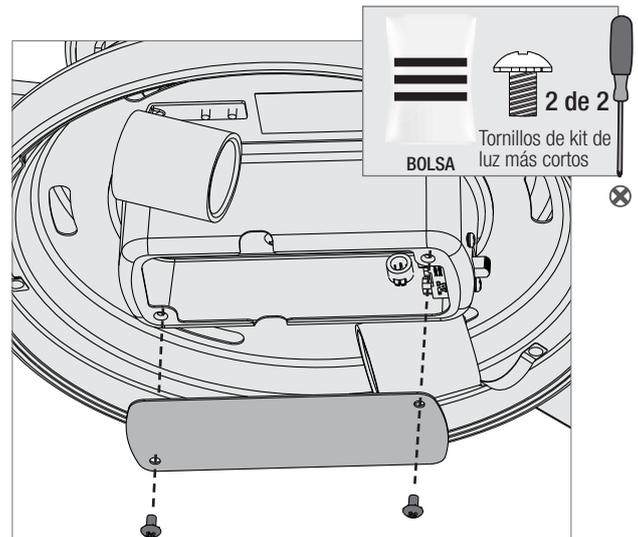
Empuje cuidadosamente todos los componentes de la caja del interruptor en la caja del interruptor, luego instale la placa de la caja del interruptor usando dos tornillos de ensamble del conjunto de lámparas con los bolsa de herrajes.
