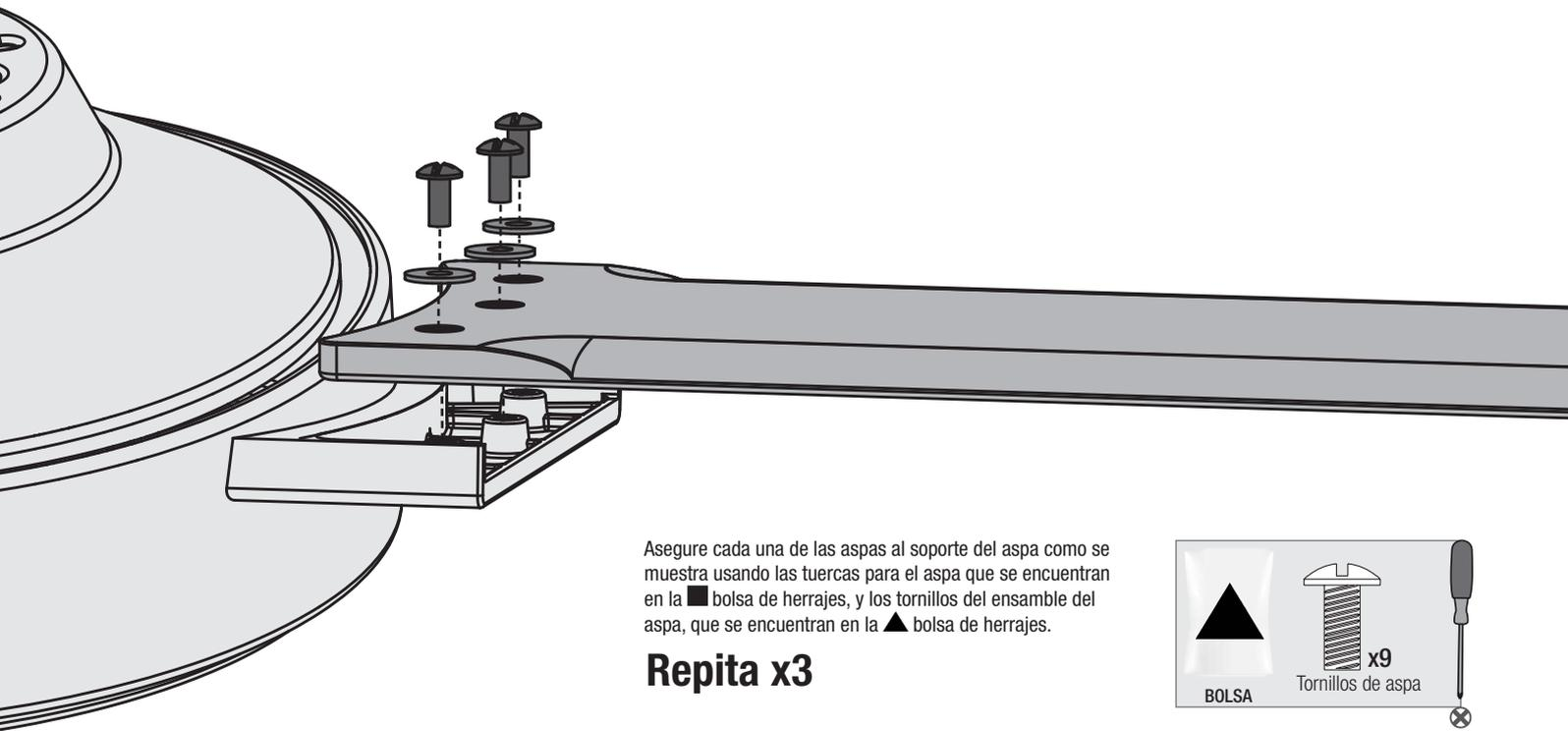
Asegure cada una de las aspas al soporte del aspa como se muestra usando las tuercas para el aspa que se encuentran en la ■ bolsa de herrajes, y los tornillos del ensamble del aspa, que se encuentran en la ▲ bolsa de herrajes.
