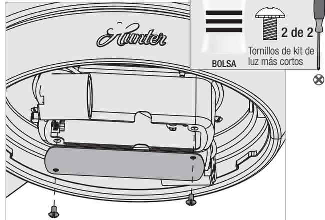
Empuje cuidadosamente todos los componentes de la caja del interruptor en la caja del interruptor, luego instale la placa de la caja del interruptor usando dos tornillos de ensamble del conjunto de lámparas que se encuentran en la
