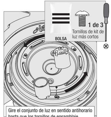
Gire el conjunto de luz en sentido antihorario hasta que los tornillos de ensamble de la caja estén firmemente colocados en el extremo angosto de las ranuras de bocallave. Instale el tornillo restante en la caja. Apriete los tres tornillos firmemente.
