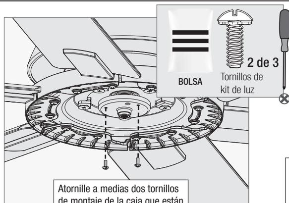
Atornille a medias dos tornillos de montaje de la caja que están en la bolsa de materiales
