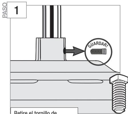
Retire el tornillo de fijación preinstalado para poder insertar la varilla.
