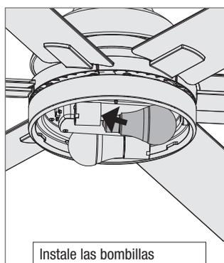
Instale las bombillas incluidas en los portalámparas. Cuando sea necesario, remplace las bombillas con unas de la misma potencia.
