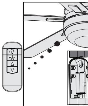
El transmisor del control remoto ya está sincronizado con el receptor y listo para usarse. El modo de atenuación está desactivado por defecto.
