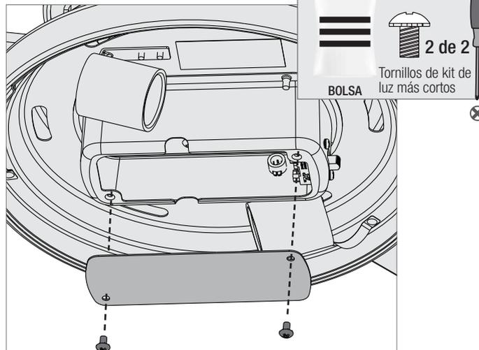
Empuje cuidadosamente todos los componentes de la caja del interruptor en la caja del interruptor, luego instale la placa de la caja del interruptor usando dos tornillos de ensamble del conjunto de lámparas que se encuentran en la
