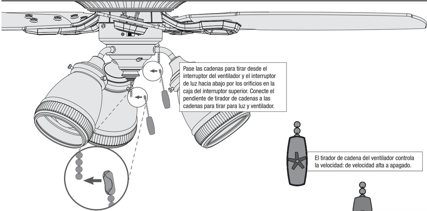
Pase las cadenas para tirar desde el interruptor del ventilador y el interruptor de luz hacia abajo por los orificios en la caja del interruptor superior. Conecte el pendiente de tirador de cadenas a las cadenas para tirar para luz y ventilador.
