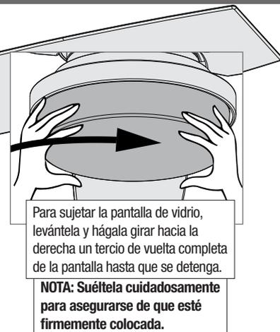
Para sujetar la pantalla de vidrio, levántela y hágala girar hacia la derecha un tercio de vuelta completa de la pantalla hasta que se detenga.
