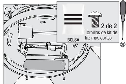
Empuje cuidadosamente todos los componentes de la caja del interruptor en la caja del interruptor, luego instale la placa de la caja del interruptor usando dos tornillos de ensamble del conjunto de lámparas que se encuentran en la bolsa de herrajes.
