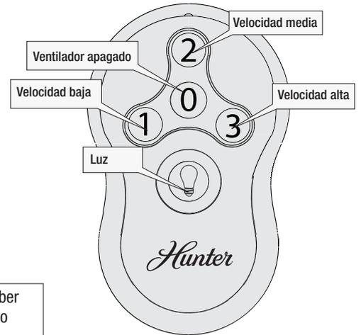
Para encender el ventilador, pulse un botón de velocidad. Las velocidades varían desde apagado (0) hasta alta (3). Presione brevemente el botón de luz para encender y apagar las luces.
