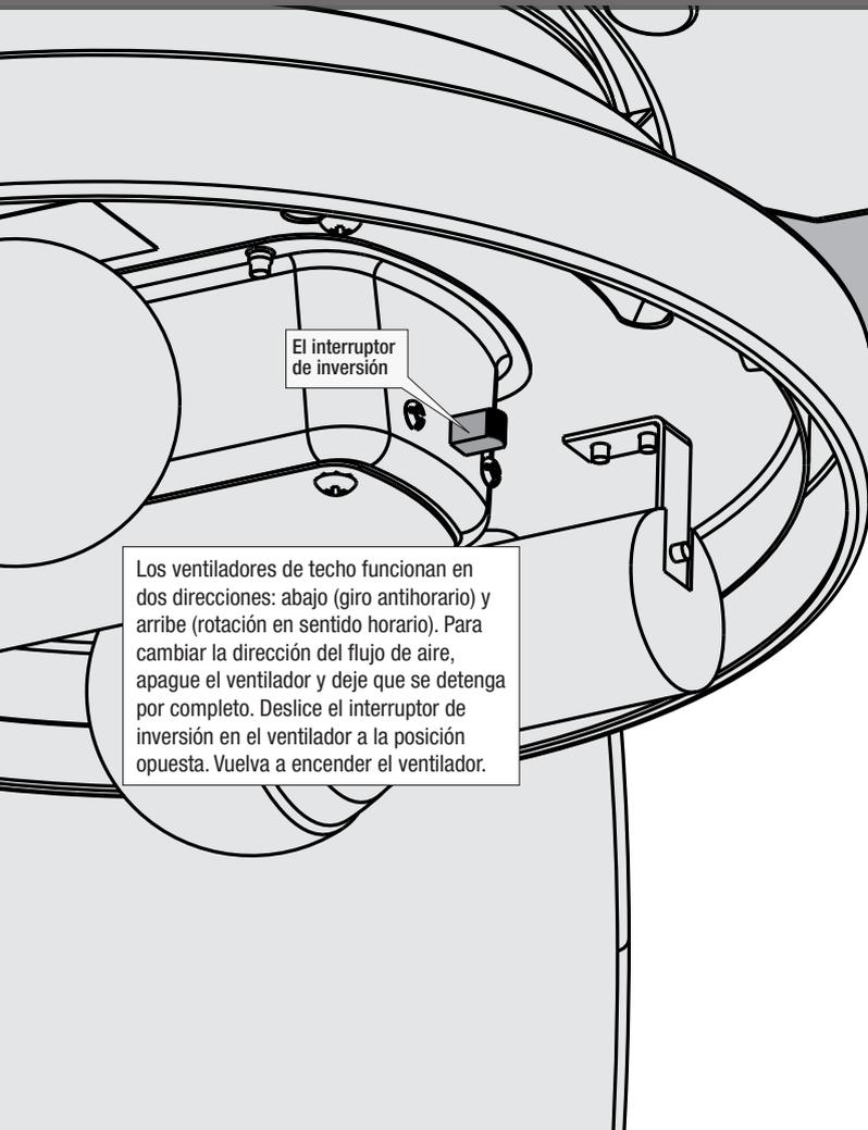
Los ventiladores de techo funcionan en dos direcciones: abajo (giro antihorario) y arriba (rotación en sentido horario). Para cambiar la dirección del flujo de aire, apague el ventilador y deje que se detenga por completo. Deslice el interruptor de inversión en el ventilador a la posición opuesta. Vuelva a encender el ventilador.
