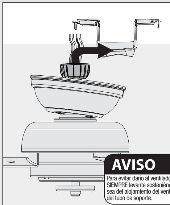
Coloque la bola de la varilla en la ranura del soporte de techo.
