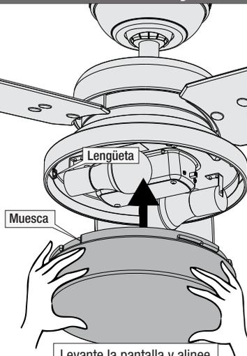
Levante la pantalla y alinee las muescas en la pantalla de vidrio con las lengüetas en el conjunto de luz.
