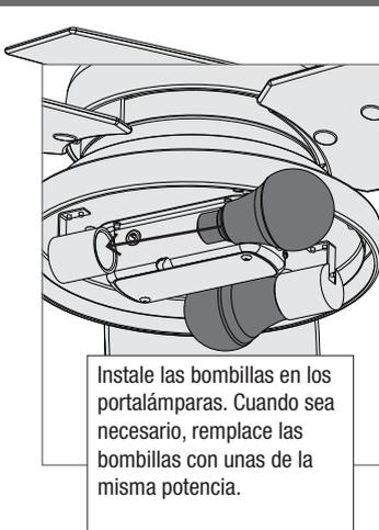
Instale las bombillas en los portalámparas. Cuando sea necesario, reemplace las bombillas con unas de la misma potencia.
