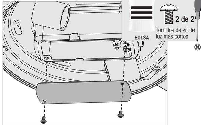
Empuje cuidadosamente todos los componentes de la caja del interruptor en la caja del interruptor, luego instale la placa de la caja del interruptor usando dos tornillos de ensamble del conjunto de lámparas que se encuentran en la
