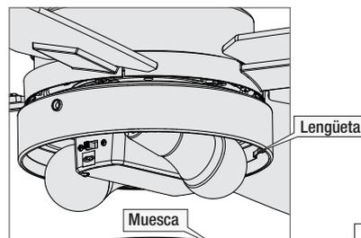
Levante la pantalla y alinee las muescas en la pantalla de vidrio con las lengüetas en el conjunto de luz.
