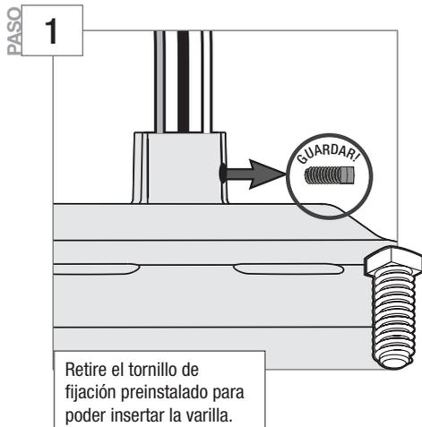
Retire el tornillo de fijación preinstalado para poder insertar la varilla.
