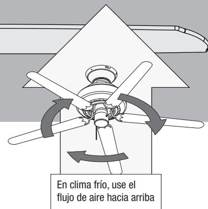
Los ventiladores de techo funcionan en dos direcciones: abajo (giro antihorario) y arriba (rotación en sentido horario). Para cambiar la dirección del flujo de aire, apague el ventilador y deje que se detenga por completo. Deslice el interruptor de inversión en el ventilador a la posición opuesta. Vuelva a encender el ventilador.
