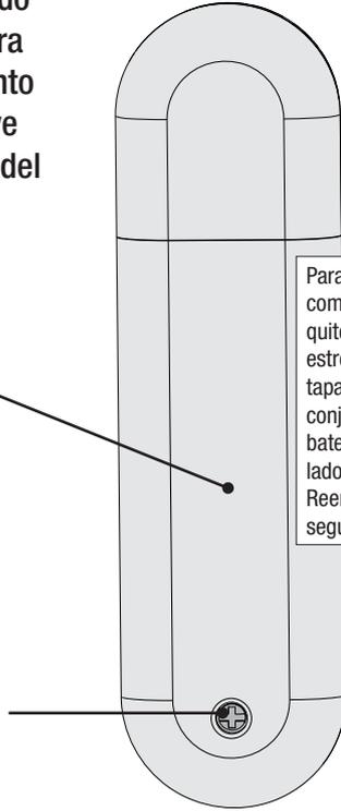
Para acceder al compartimiento de la batería quite el pequeño tornillo estrella (Phillips) que fija la tapa del compartimiento al conjunto del transmisor. La batería debe instalarse con el lado positivo (+) hacia arriba. Reemplace la batería CR2032 según sea necesario.
