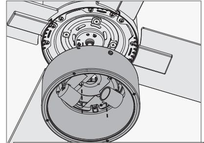
Alinee las ranuras de bocallave en la parte superior del conjunto de lámparas con los tornillos de ensamble parcialmente instalados. Envuelva los orificios de bocallave alrededor de los tornillos y gire en sentido contrario de las manecillas.
