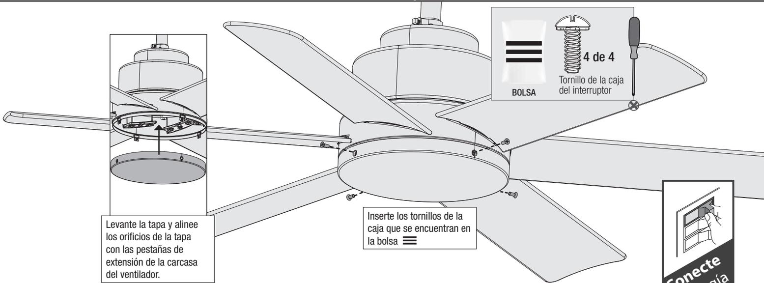
Levante la tapa y alinee los orificios de la tapa con las pestañas de extensión de la carcasa del ventilador.
