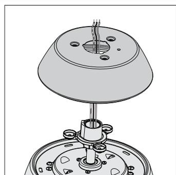
Pase los alambres a través de la tapa superior. Coloque la tapa superior sobre el alojamiento del motor de modo que los orificios en la tapa superior se alineen con los orificios en el alojamiento del motor y en el adaptador.
