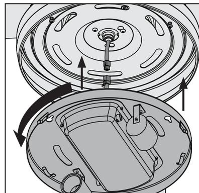
Asegúrese de que todos los cables del ventilador y del conjunto de lámparas estén ajustados dentro del centro del conjunto de lámparas, y que no estén atascados entre la caja superior del interruptor y el conjunto de lámparas o colgando de los lados.
