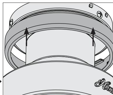
Con las dos manos empuje el anillo de la moldura de campana hasta la parte superior de la campana. Escuchará un clic y el anillo de la moldura de campana quedará asegurado en posición.
