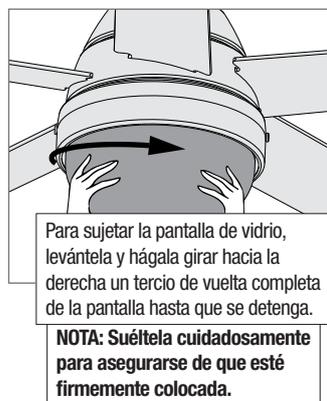
Para sujetar la pantalla de vidrio, levántela y hágala girar hacia la derecha un tercio de vuelta completa de la pantalla hasta que se detenga.
