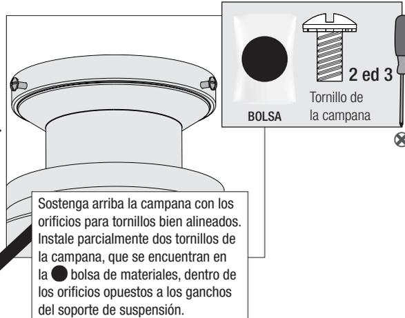
Sostenga arriba la campana con los orificios para tornillos bien alineados. Instale parcialmente dos tornillos de la campana, que se encuentran en la ● bolsa de materiales, dentro de los orificios opuestos a los ganchos del soporte de suspensión.
