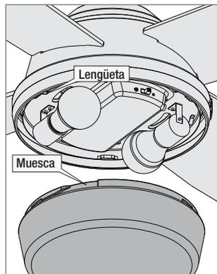
Ubique las muescas del borde externo de la pantalla de vidrio de modo que se alineen con las pestañas en la superficie interna del borde del artefacto de iluminación.
