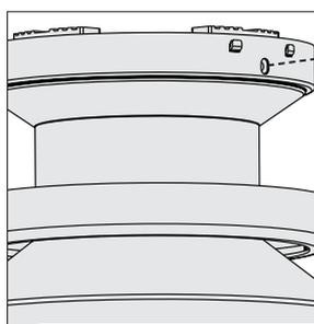
Instale parcialmente un tornillo de la campana, encontrado en la ● bolsa de materiales, que está entre los ganchos del soporte de suspensión. Cuando los orificios estén bien alineados, apriete firmemente los tres tornillos de la campana.
