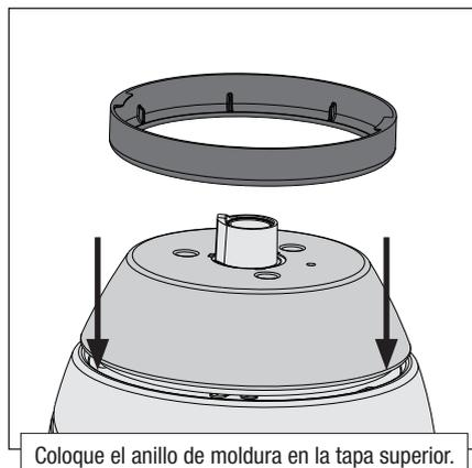
Coloque el anillo de moldura en la tapa superior.
