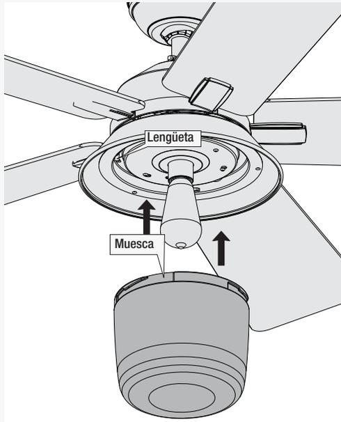
Ubique las muescas del borde externo de la esfera de modo que se alineen con las pestañas en el equipo de instalación de lámpara. Eleve cuidadosamente la esfera dentro del equipo de instalación de lámpara tanto como sea posible. Gire la esfera en sentido horario hasta que esté sujeta firmemente en su posición por las tres pestañas.
