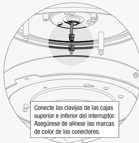
Conecte las clavijas de las cajas superior e inferior del interruptor. Asegúrese de alinear las marcas de color de los conectores.
