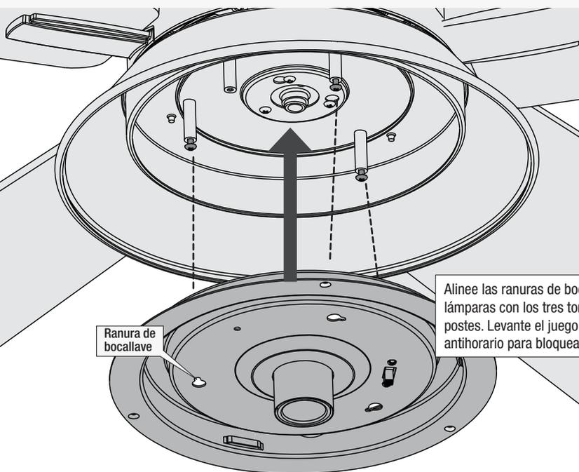
Alinee las ranuras de bocallave en el conjunto de lámparas con los tres tornillos de montaje en los postes. Levante el juego de luces y gírelo en sentido antihorario para bloquearlo en su lugar.
