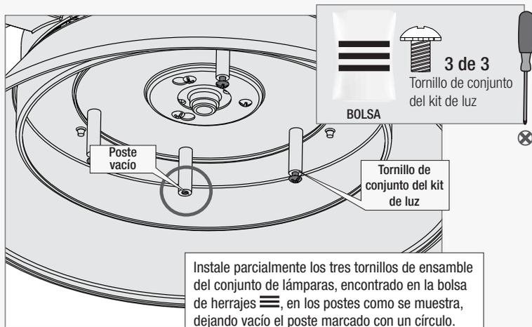
Instale parcialmente los tres tornillos de ensamble del conjunto de lámparas, encontrado en la bolsa de herrajes
