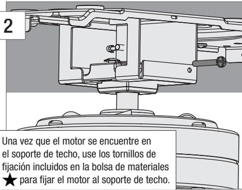
Una vez que el motor se encuentre en el soporte de techo, use los tornillos de fijación incluidos en la bolsa de materiales ★ para fijar el motor al soporte de techo.
