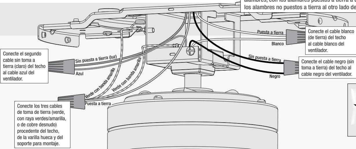
Conecte el segundo cable sin toma a tierra (claro) del techo al cable azul del ventilador.
