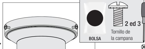
Sostenga arriba la campana con los orificios para tornillos bien alineados. Instale parcialmente dos tornillos de la campana, que se encuentran en la ● bolsa de materiales, dentro de los orificios opuestos a los ganchos del soporte de suspensión.
