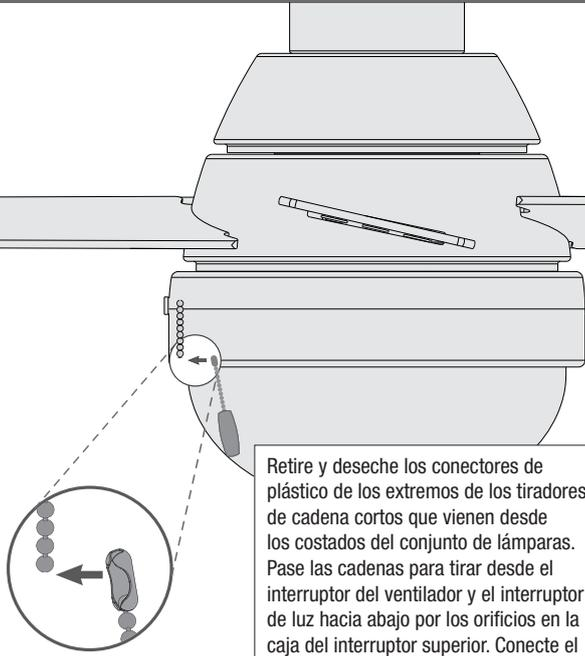
Retire y deseche los conectores de plástico de los extremos de los tiradores de cadena cortos que vienen desde los costados del conjunto de lámparas. Pase las cadenas para tirar desde el interruptor del ventilador y el interruptor de luz hacia abajo por los orificios en la caja del interruptor superior. Conecte el pendiente de tirador de cadenas a las cadenas para tirar para luz y ventilador.
