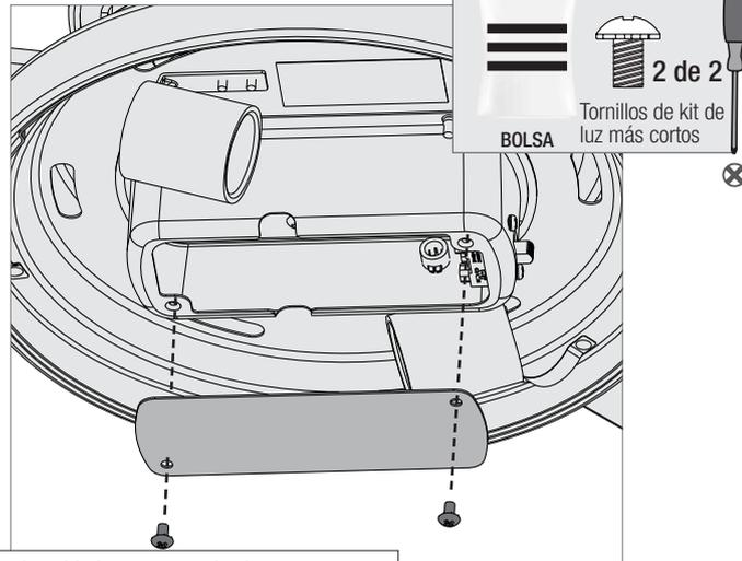
Empuje cuidadosamente todos los componentes de la caja del interruptor en la caja del interruptor, luego instale la placa de ensamble del conjunto de lámparas que se encuentran en la
