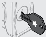
Retirer lentement la clé du cylindre tout en bougeant doucement pour déterminer la profondeur pour laquelle la clé a été programmée. En cas de succès, tournez la clé à 90° et l'anse s'ouvrira.
