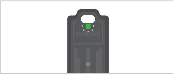
Le porte-clés électronique qui était en mode veille s'est allumé, l'activation est en cours, ou Kevo reconnaît le porte-clés électronique pendant le verrouillage ou le déverrouillage.
