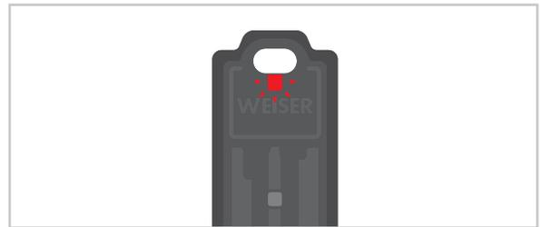
Le porte-clés électronique se met en mode veille, ou le niveau de charge de sa pile est faible.
