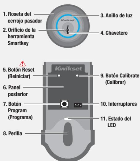
1. Toque la cerradura Kevo en cualquier parte de la superficie metálica detrás del anillo de luz para cerrar y abrir.
