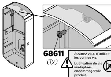
Lorsque le hublot est verrouillé, vous devez retirer le couvercle intérieur entier et les vis pour accéder au bloc-piles et aux boutons.
