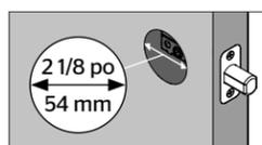
Une bague d'adaptation est nécessaire pour la pose. Posez-la sur l'ensemble extérieur.
