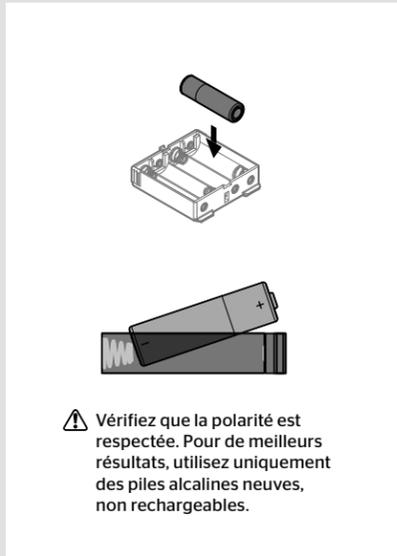
**B** La porte étant ouverte, insérez le bloc-piles pour amorcer le processus automatique d'orientation de la porte.
