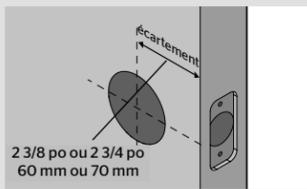
**E** Mesurez pour confirmer que le trou pratiqué dans le chant de la porte est de 25 mm (1 po).
