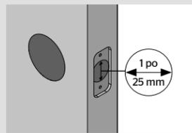
**F** Mesurez pour confirmer que la porte mesure entre 35 mm et 51 mm (1 3/8 po - 2 po) d'épaisseur.
