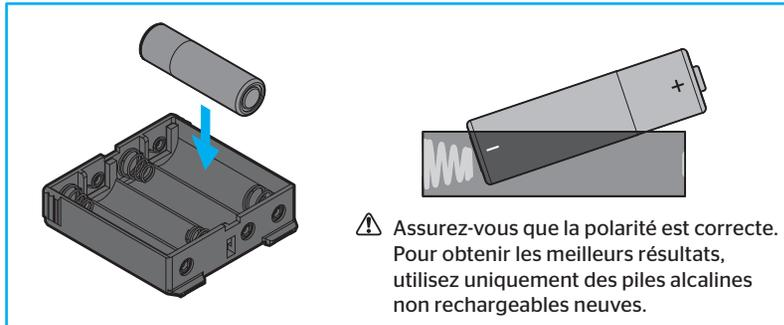
**B** **IMPORTANT:** Assurez-vous que la porte est ouverte. Insérez le bloc-piles en APPUYANT sur le bouton « Program » et en le MAINTENANT enfoncé. Relâchez le bouton lorsque le bloc-piles se trouve complètement à l'intérieur de la serrure.
