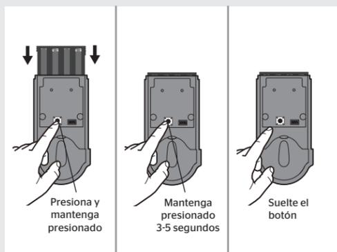
**B** El estado del LED titila en color rojo y verde, y la cerradura emite un pitido. Presione y suelte el botón Programa nuevamente. El perno de retención se retraerá y extenderá por sí solo.
