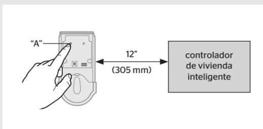
El controlador y la cerradura deben permanecer estacionarios por un período de 60 segundos durante el proceso de sincronización.
