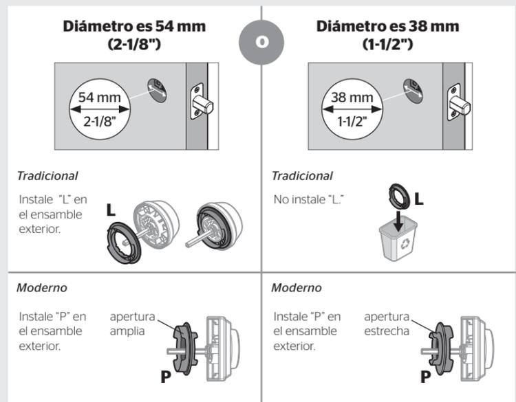
**C** Instale el ensamblaje exterior y la placa de montaje.
