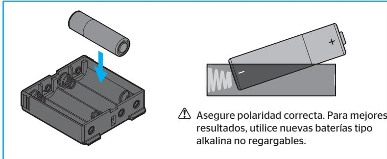
**B** **IMPORTANTE:** Verifique que la puerta esté abierta. Inserte el paquete de baterías mientras presiona y mantenga presionado el botón Programa. Suelte el botón cuando el paquete de baterías se encuentre en su totalidad dentro de la parte interna de la cerradura.
