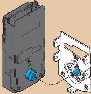
**b** Fije el ensamblaje interior con dos (2) tornillos suministrados.
