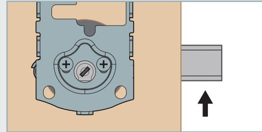
En el ensamblaje interior, mueva el interruptor #2 a la posición superior.
