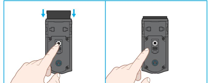
**C** **IMPORTANTE:** El estado del LED titila en color rojo y verde, y la cerradura emite un pitido. presione y suelte el botón Programa nuevamente.
