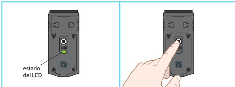
**D** El perno de retención se retraerá y extenderá por sí solo para conocer la orientación de la puerta.
